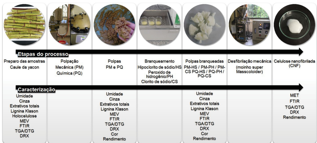
FIGURA 8 – ESQUEMA GERAL DA METODOLOGIA UTILIZADA PARA OBTENÇÃO E CARACTERIZAÇÃO DA FIBRA DE CELULOSE DO CAULE DA YACON
