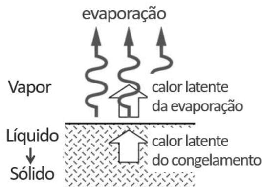
Figura 5 - Ilustração do processo de congelamento a vácuo.
