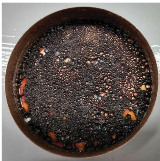
Figura 14 - Perdas no processo de secagem em camada de espuma, ensaio a 50 °C e 15mm.
