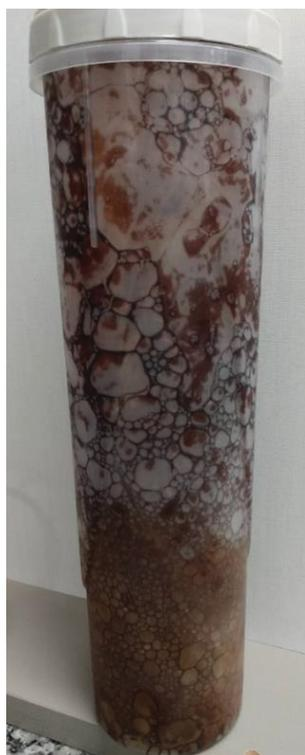
Figura 17 - Camada de espuma produzida durante o congelamento a vácuo.
