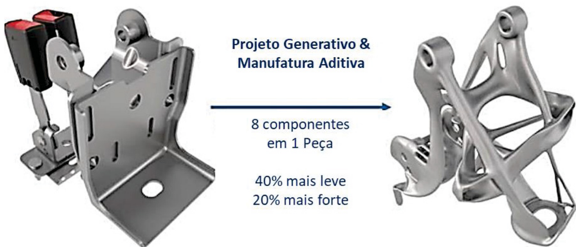
FIGURA 31: Otimização topológica com objetivo em redução de subcomponentes e peso de uma peça
