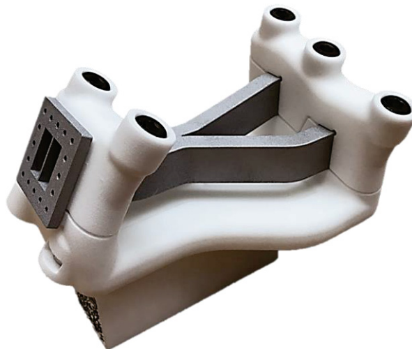
FIGURA 9: Dispositivo Auxiliar utilizado para Usinagem de peças metálicas
