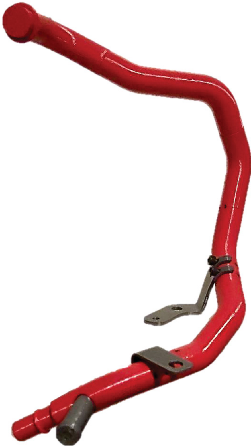
FIGURA 59: Peça Modelo do Tubo de Resfriamento concluída e pronta para ser submetida aos ensaios dimensionais
