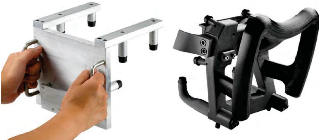
FIGURA 8: Dispositivo de montagem utilizado no processo de fabricação da BMW
