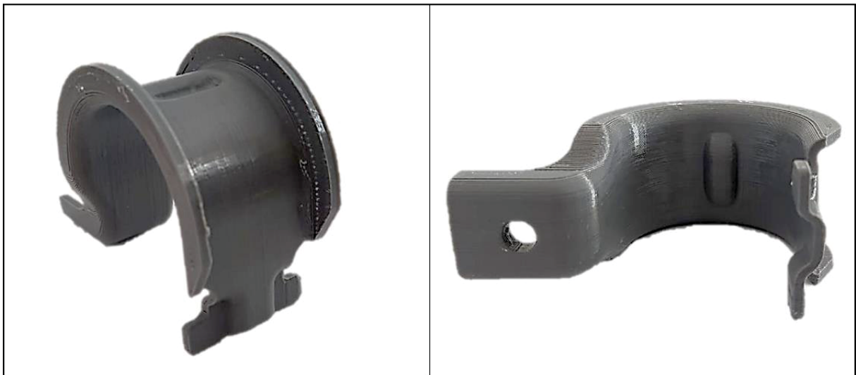
FIGURA 53: Peça Modelo do componente Algema concluída e pronta para avaliação dimensional
