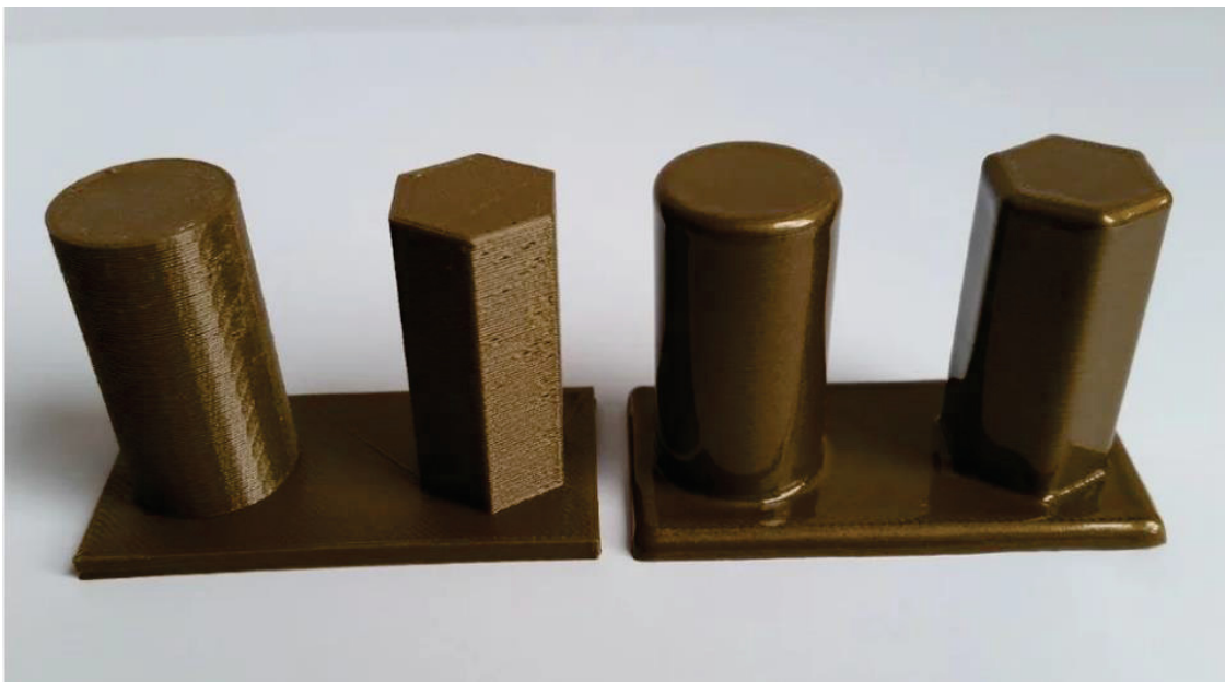
FIGURA 19: Exemplo de peça com e sem Pós-Processamento. Peça da esquerda sem pós-processamento e da direita pós-processada com vapor de acetona 100%.
