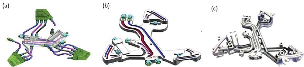
FIGURA 27: Otimização topologia em sistemas de distribuição de fluido, sendo (a) Projeto convencional com mangueiras (110 g), (b) Projeto monolítico fresado (200 g), (c) Design otimizado para MA (100 g)
