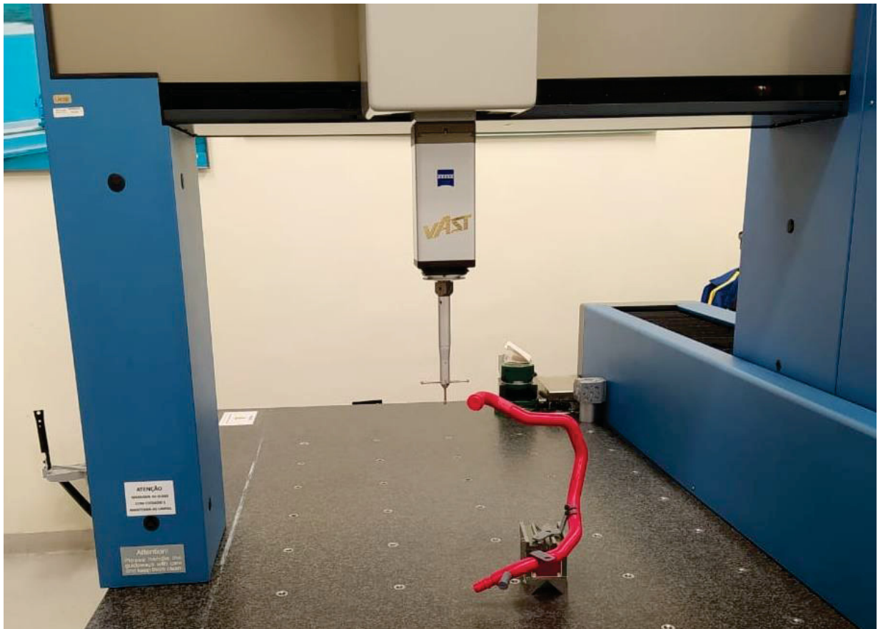
FIGURA 61: Tubo de Resfriamento posicionado de forma representativa na máquina de medição
