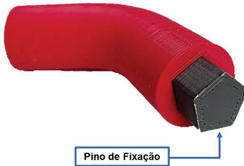
FIGURA 57: Ilustração do encaixe montado e utilizado para interligar às sete partes do tubo principal
