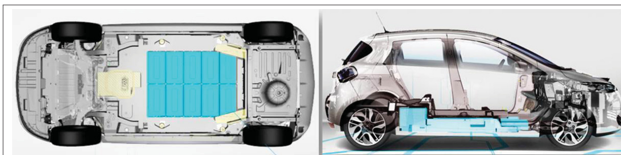
FIGURA 61 – Conjunto ( pack ) de baterias - Renault ZOE ®
