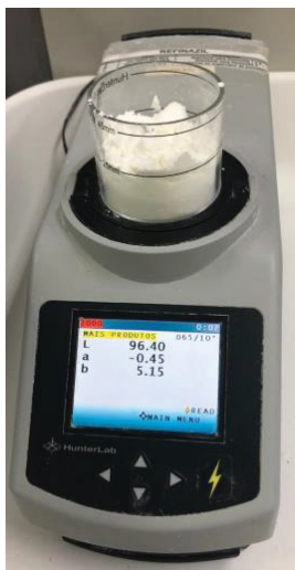
FIGURA 10 - MEDIÇÃO DA COR NO EQUIPAMENTO COLORFLEX EZ
