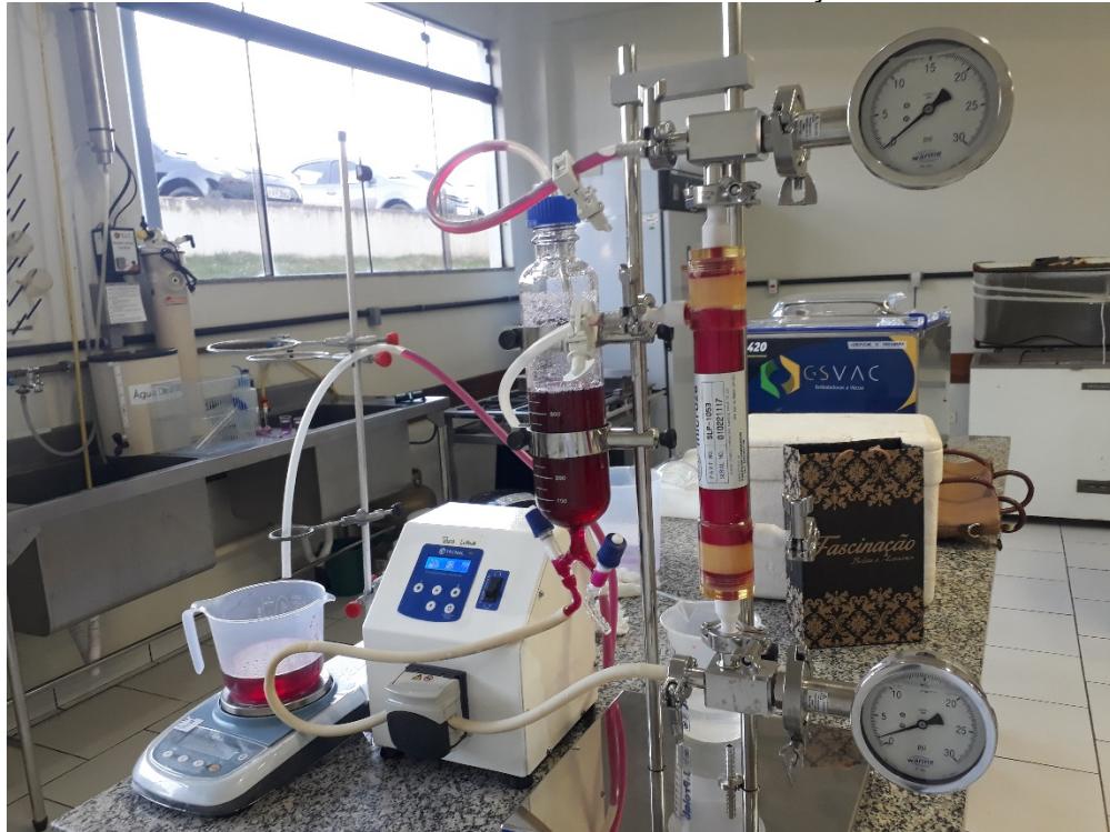
FIGURA 1 – SISTEMA DE ULTRAFILTRAÇÃO
