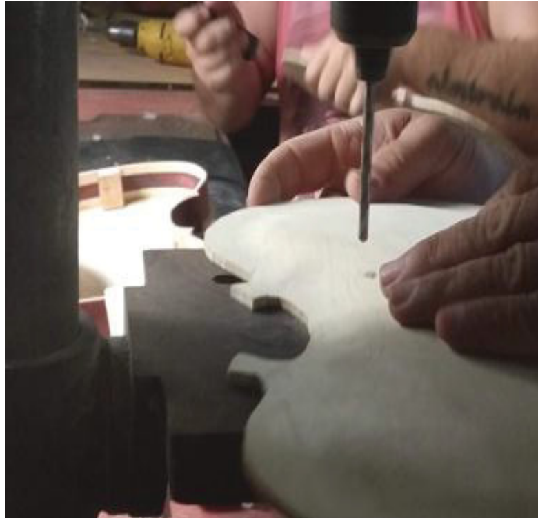
FIGURA 38 – PROCESSO PARA FAZER A BOCA DA RABECA
