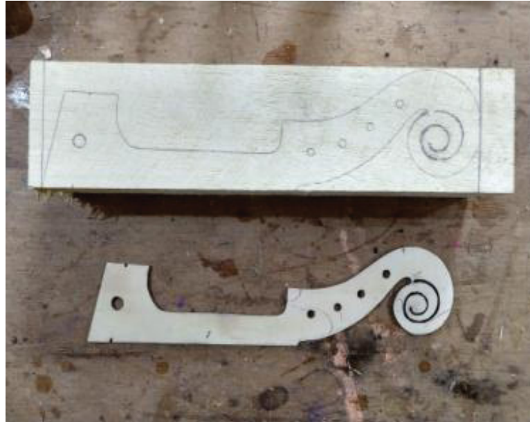
FIGURA 25 – DESENHO DO BRAÇO DA RABECA DEITO EM UM TACO DE CAIXETA
