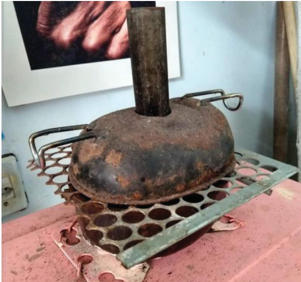
FIGURA 8 – CURVADOR DE LATERAL FEITO POR MESTRE ZECA I
