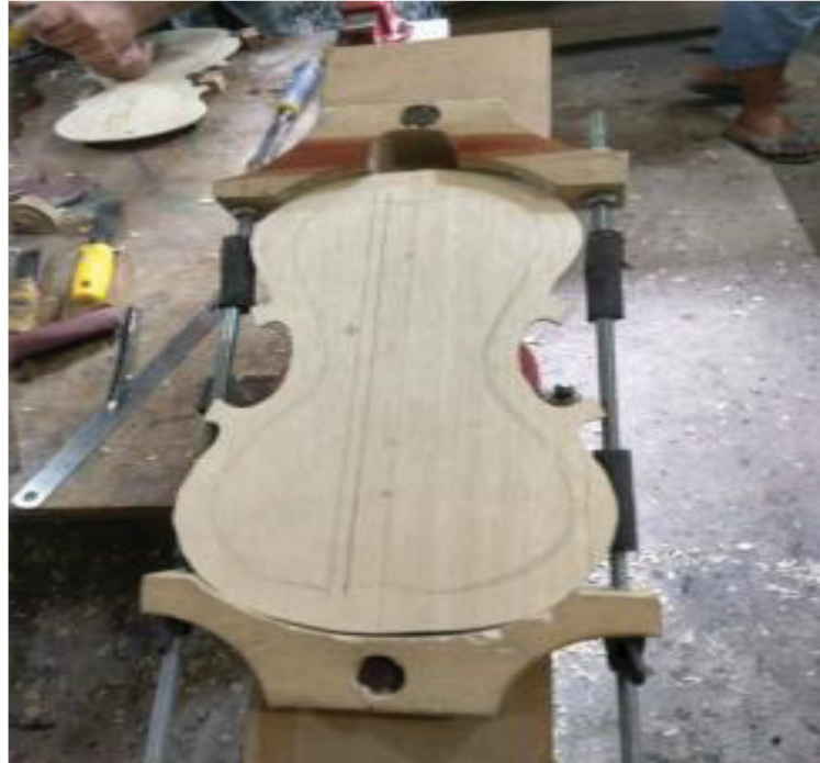
FIGURA 37 – PROCESSO DE ESCAVAR O INTERIOR DO TAMPO
