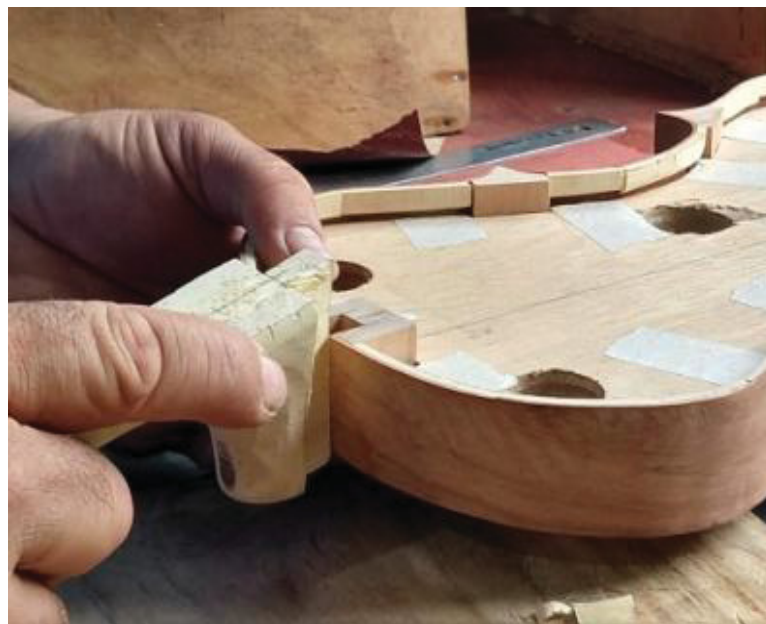
FIGURA 33 – COLAGEM DO BRAÇO
