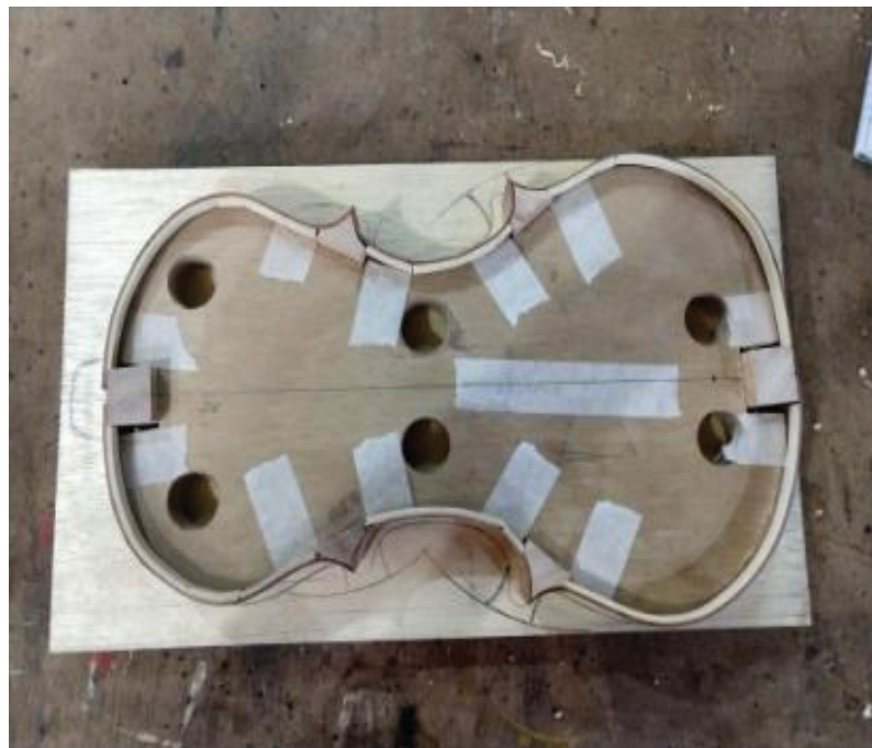
FIGURA 12 – LATERAIS AINDA NA FORMA SOBRE UMA TÁBUA DE CAXETA
