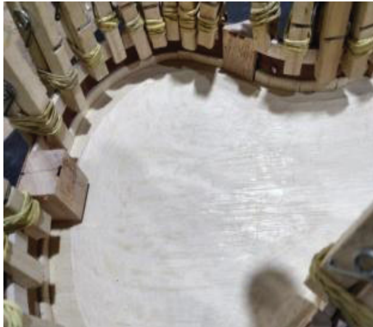
FIGURA 36 – PROCESSO DE COLAGEM DO TAMPO
