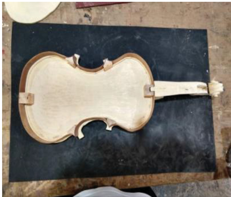
FIGURA 35 – FUNDO COLADO ÀS LATERAIS E AO BRAÇO
