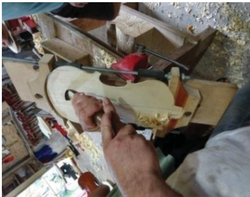
FIGURA 21 – USO DA FERRAMENTA “ALEGRE” PARA ESCAVAR O FUNDO
