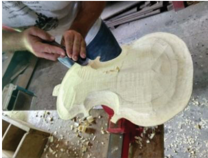
FIGURA 18 – UTILIZAÇÃO DO FORMÃO GOIVA PARA RETIRAR O EXCESSO DE MADEIRA DAS LATERAIS
