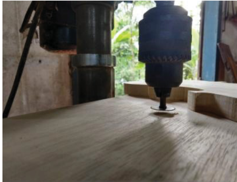
FIGURA 16 – PEÇA DE RELÓGIO ADAPTADA EM UMA FURADEIRA DE BANCADA, PARA MARCAR O CONTOURO DO FUNDO
