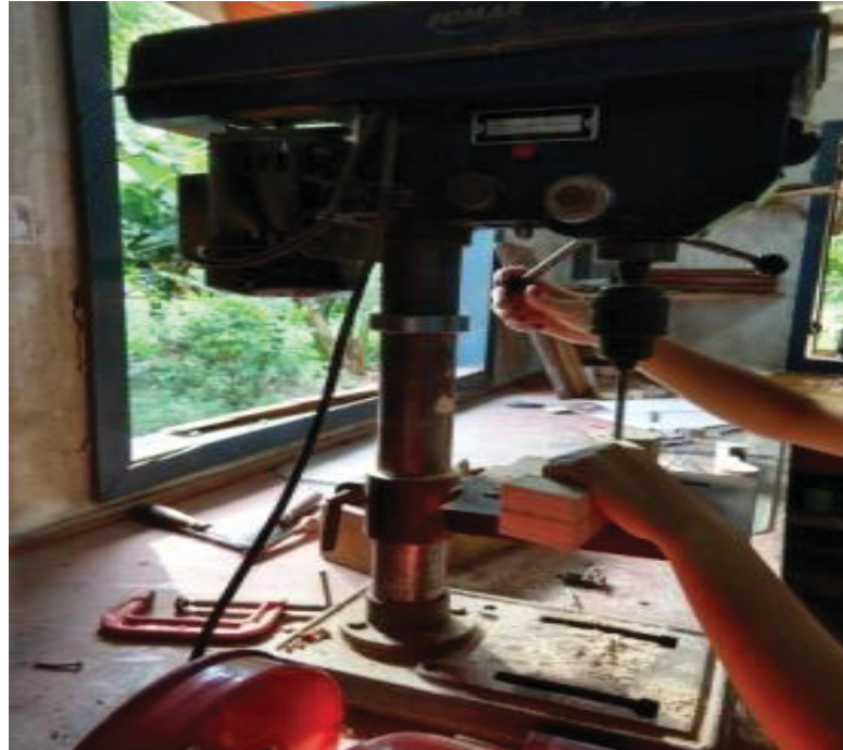
FIGURA 27 – FUROS DO BRAÇO FEITOS NA FURADEIRA DE BANCADA
