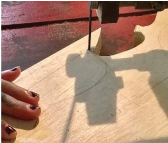
FIGURA 15 – RECORTE DO FUNDO FEITO NA SERRA FITA
