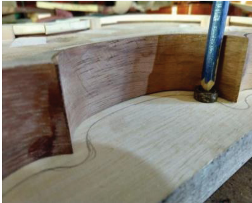
FIGURA 13 – TÉCNICA PARA DESENHAR O TAMPO UTILIZADO POR MESTRE AORELIO
