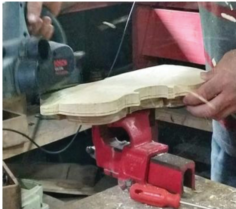
FIGURA 17 – RETIRADA DO EXCESSO DE MADEIRA DO FUNDO COM SEPILHADEIRA ELÉTRICA
