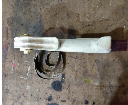
FIGURA 32 – PROCESSO DE CONSTRUÇÃO DO BRAÇO V
