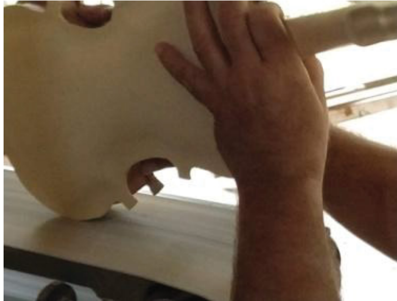
FIGURA 42 – ACABAMENTO FEITO NA LIXADEIRA ELÉTRICA
