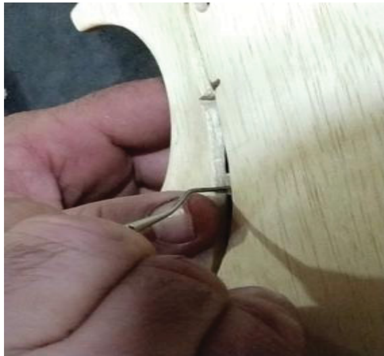
FIGURA 53 – MOMENTO EM QUE A ALMA É COLOCADA DENTRO DA RABECA
