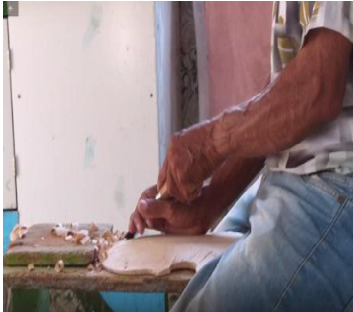
FIGURA 46 – PROCESSO DE CONSTRUÇÃO DO TAMPO DA RABECA FEITO PELO MESTRE ZECA II
