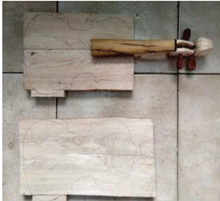
FIGURA 44 – DESENHO DO TAMPO E DO FUNDO DA RABECA FEITO PELO MESTRE ZECA
