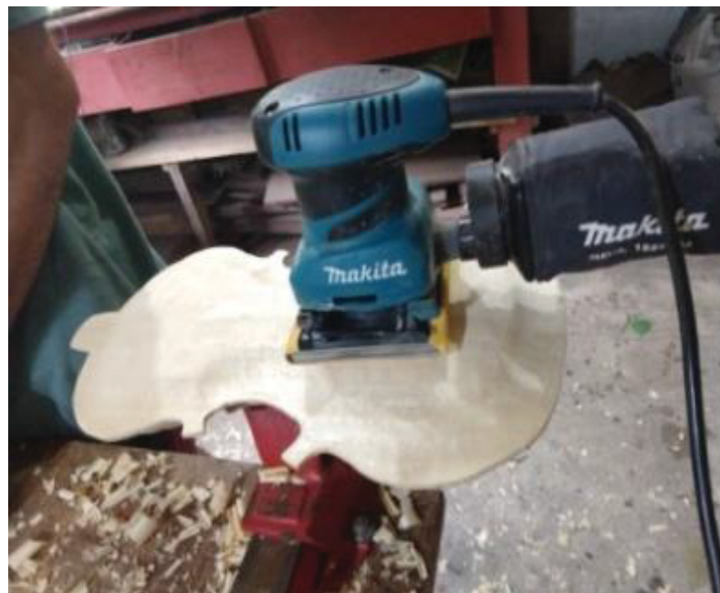
FIGURA 19 – PROCESSO PARA LIXAR O FUNDO I
