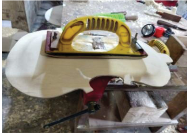
FIGURA 20 – PROCESSO PARA LIXAR O FUNDO II
