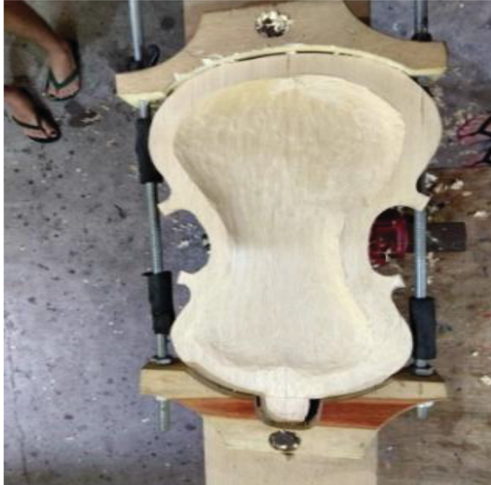
FIGURA 22 – FERRAMENTA CONSTRUÍDA POR MESTRE AORELIO PARA SEGURAR O FUNDO NA HORA DE ESCAVAR
