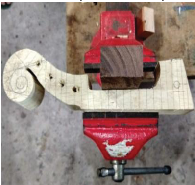
FIGURA 28 – PROCESSO DE CONSTRUÇÃO DO BRAÇO I
