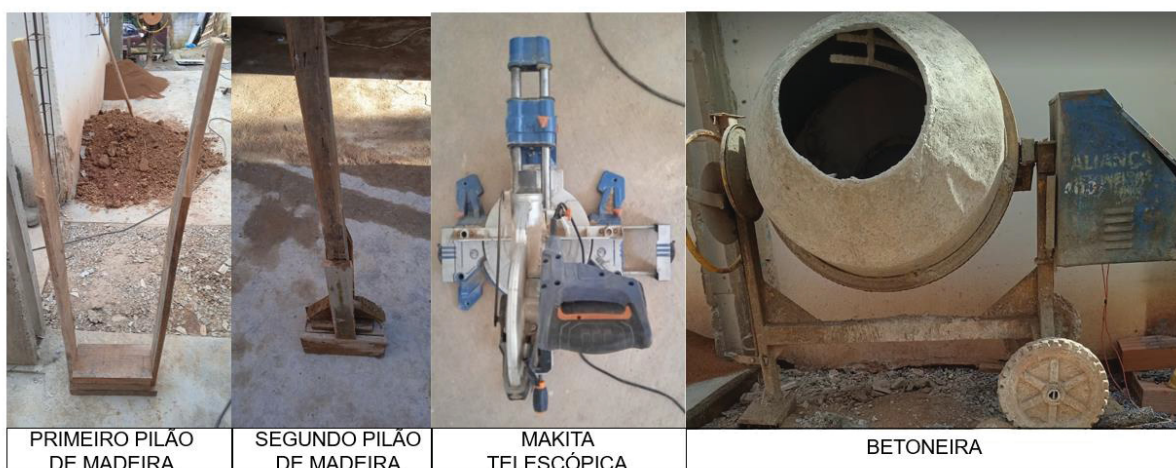
FIGURA 46 – FERRAMENTAS: PILÕES, MAKITA TELESCÓPICA E BETONEIRA
