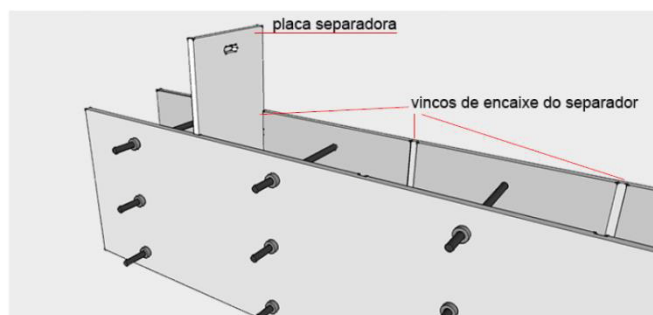
FIGURA 21 – PROJETO DA FÔRMA CANTEIRO USP
