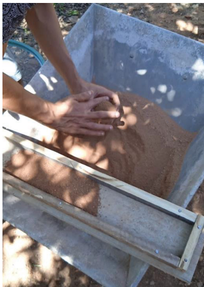
FIGURA 44 – SELEÇÃO, SECAGEM, PENEIRAMENTO E FEITURA DOS CORPOS DE PROVA
