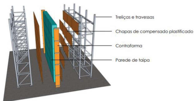
FIGURA 19 – ESQUEMA FÔRMA TAIPAL
