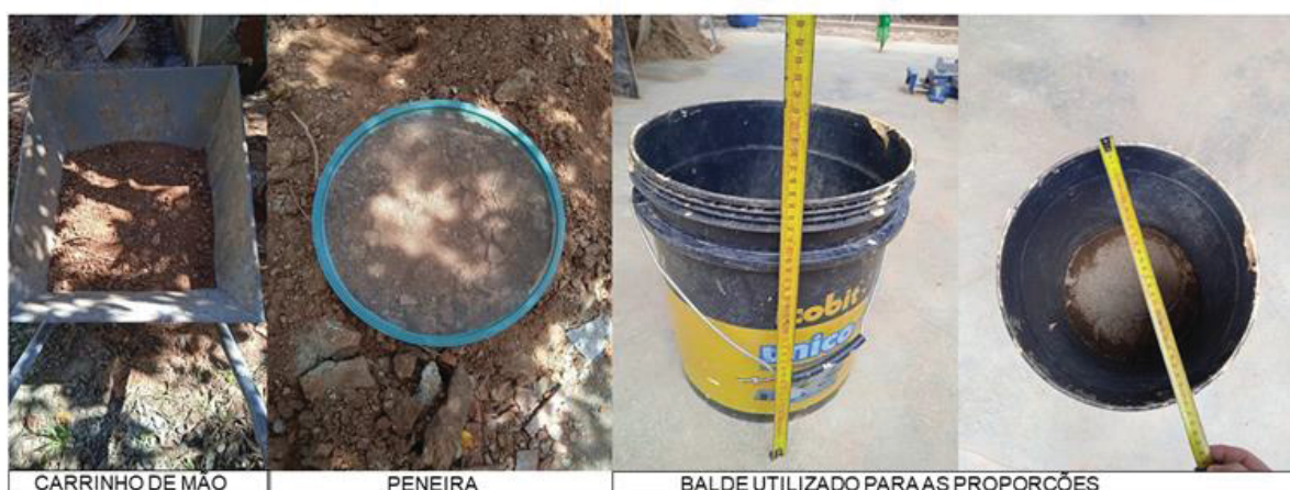
FIGURA 47 – FERRAMENTAS PARA O TRANSPORTE DA MASSA AO TAIPAL
