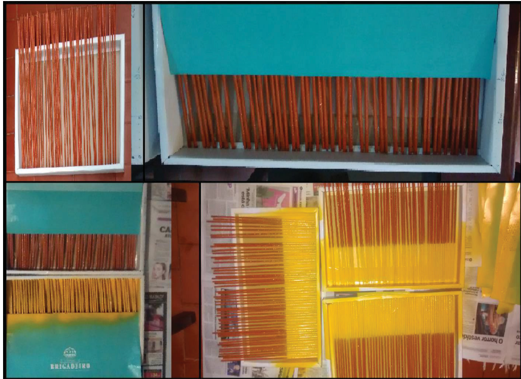
FIGURA 2 - CONFECÇÃO DOS PINOS PARA MONITORAMENTO DE EROSÃO
