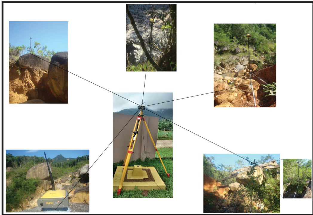
FIGURA 12 - ANTENA GNSS DUPLA FREQUÊNCIA OBTENDO COORDENADAS NA BASE E NOS PONTOS DE CONTROLE MONITORADOS COM GNSS ROVER.
