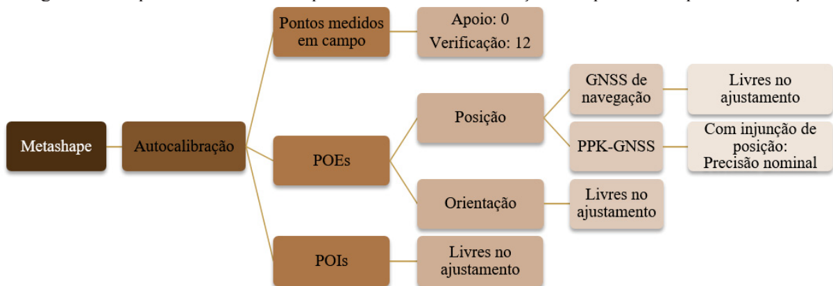
Figura 6 – Esquema-resumo dos experimentos de autocalibração sem pontos de apoio Metashape
