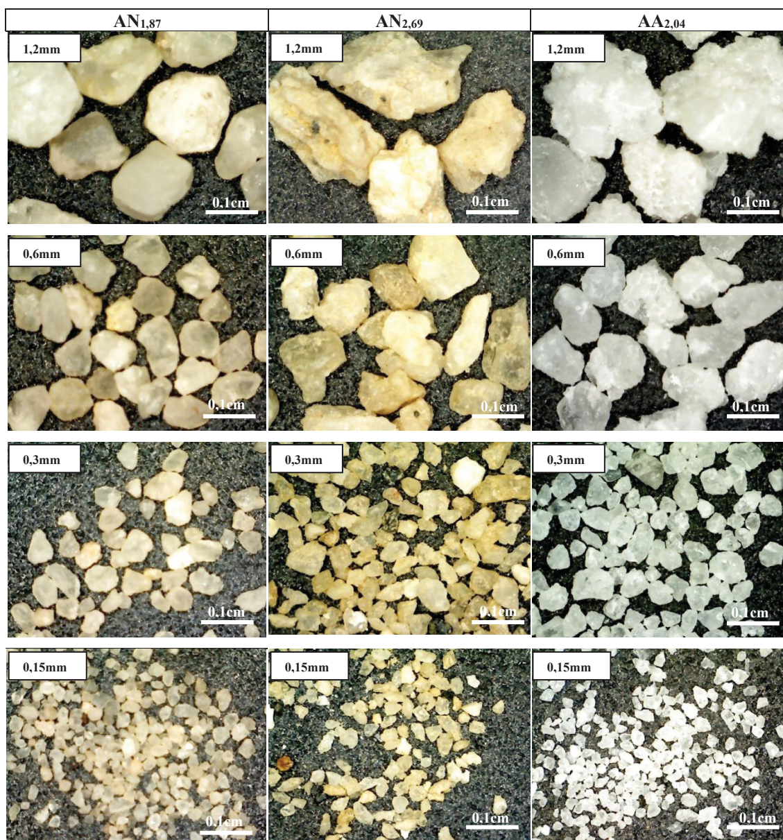
FIGURA 14 – IMAGENS DO MICROSCÓPIO DIGITAL PARA OS AGREGADOS DAS ARGAMASSAS DOSADAS EM LABORATÓRIO DA ESQUERDA PARA A DIREITA, AN_{1,87} , AN_{2,69} E AA_{2,04}
