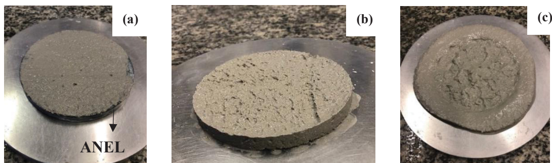
FIGURA 25 – MOLDAGEM DA ARGAMASSA PARA ENSAIO DE SQUEEZE FLOW : (A) ARGAMASSA MOLDADA COM ANEL DO GABARITO; (B) ARGAMASSA SEM A PRESENÇA DO ANEL DO GABARITO SEM ESPALHAMENTO DO MATERIAL; (C) ARGAMASSA LOGO APÓS A RETIRADA DO GABARITO COM ESPALHAMENTO DO MATERIAL NO PRATO
