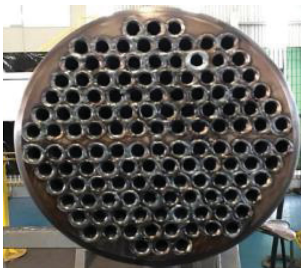
FIGURA 27 – TUBOS SOLDADOS PELO PROCESSO TIG NO ESPELHO DO TROCADOR
