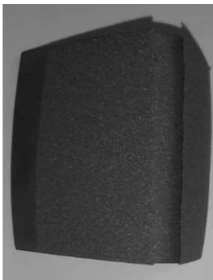
FIGURA 60 - DESPLACAMENTO DO REVESTIMENTO
