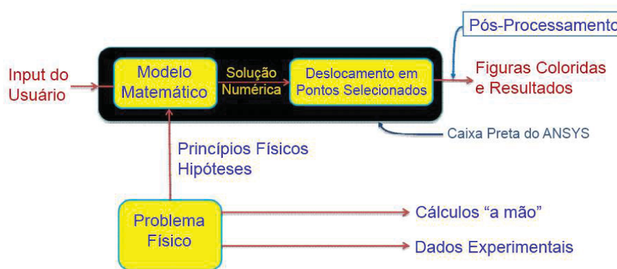
FIGURA 78 – Modelo de Funcionamento do Método de Elementos Finitos (BHASKARAN, 2018)
