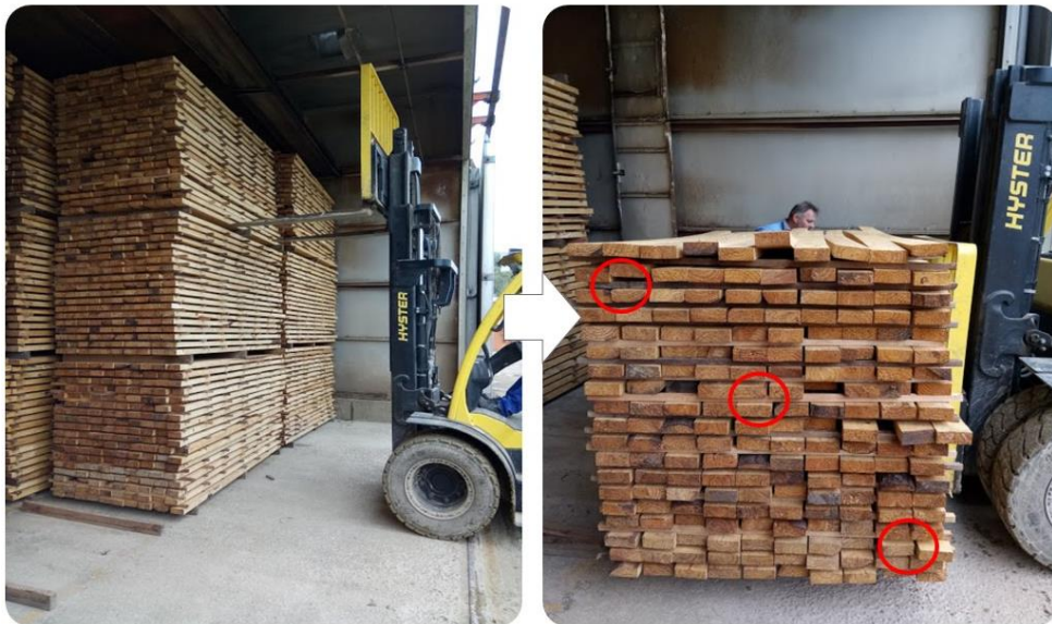
FIGURA 04 - SEQUENCIA DE LOCALIZAÇÃO E OBTENÇÃO DAS PILHAS E TÁBUAS DENTRO DA ESTUFA
