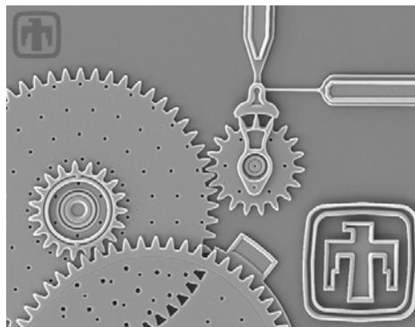
Dispositivos MEMS são tipicamente construídos sobre um substrato (chip) e podem conter também a eletrônica para interagir com o dispositivo MEMS. Devido à pequena dimensão e massa, os componentes MEMS podem ser acionados eletrostaticamente (efeitos bimetálicos e/ou piezelétrico também podem ser usados).
