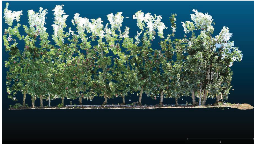
Figura 35 - Apresentação de Nuvem de pontos referente as plantas da Linha L4, gerada por Fotogrametria.
