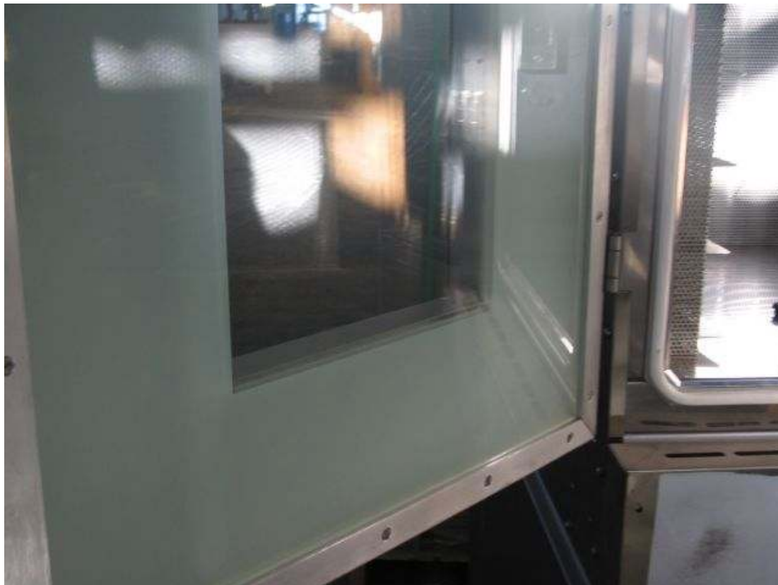
FIGURA 21 – FOTO FORNO DE CONVECÇÃO – PORTA COM VIDRO DUPLO
