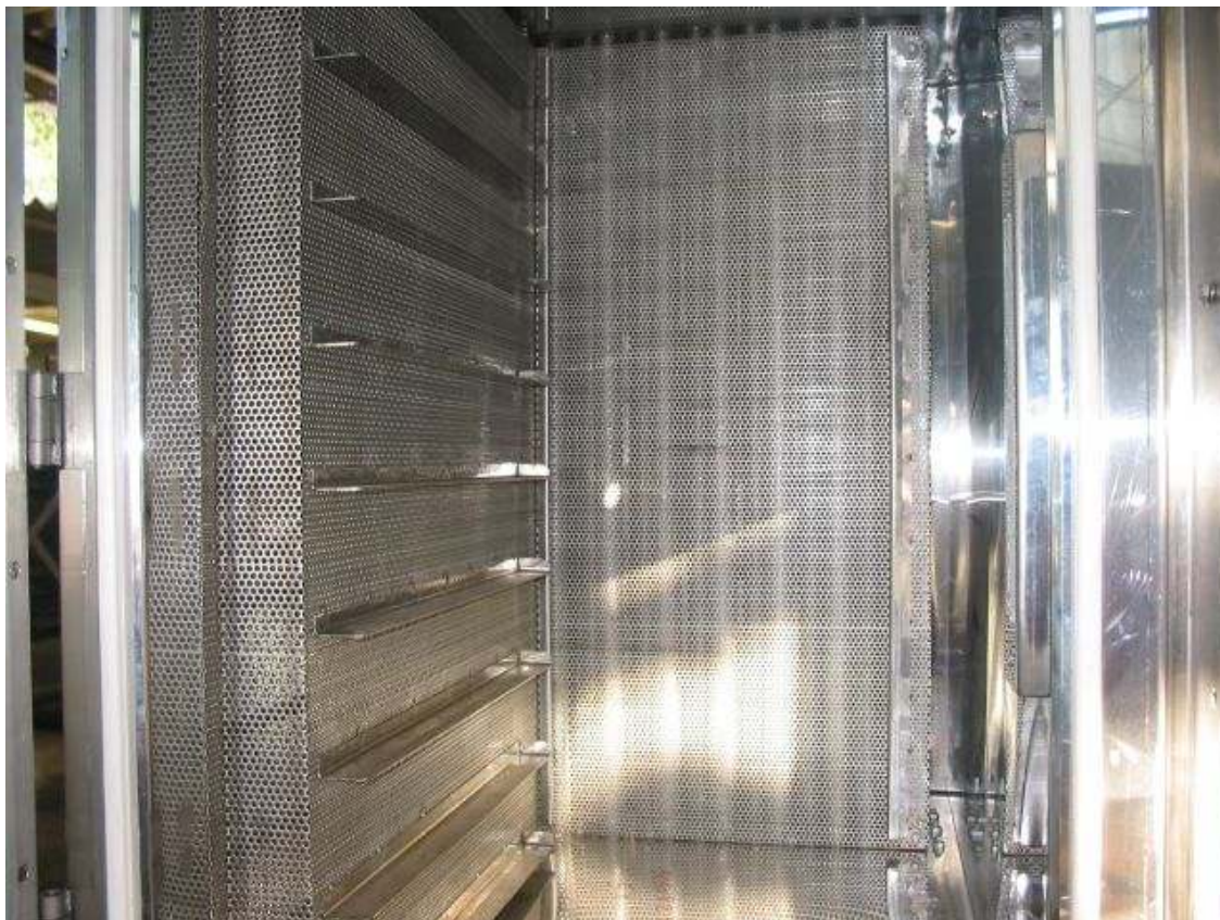
FIGURA 17 – FOTO FORNO DE CONVECÇÃO – CAMARA DE COZIMENTO
