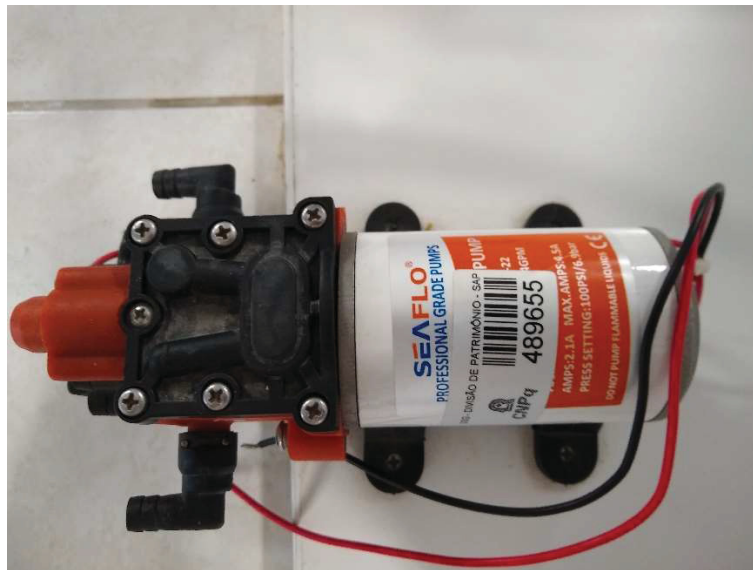
Figura 11 - Bomba de diafragma SEAFLO.
