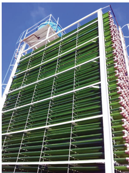
Figura 5 - Fotobiorreatores tubulares compactos do NPDEAS.
