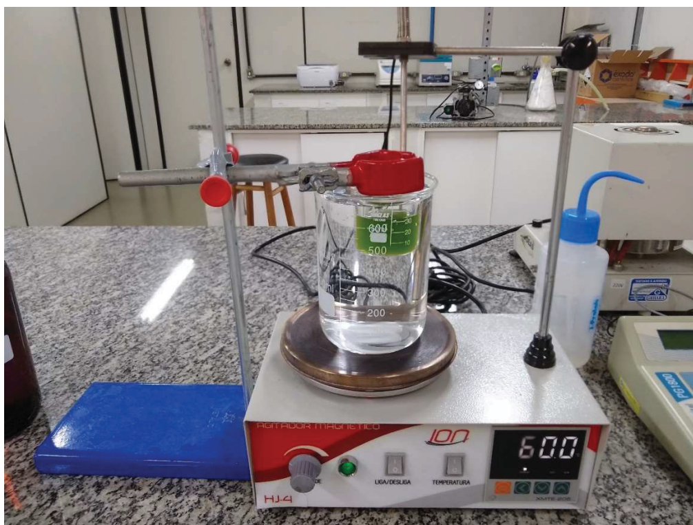
Figura 25 - Sistema montado para os ensaios de floculação.
