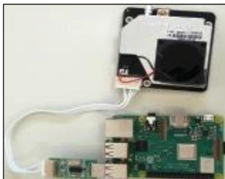
**Figura 16** – Conjunto *Raspberry Pi* + Sensor SDS011.
