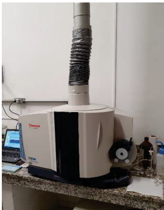
FIGURA 9 - ESPECTRÔMETRO DE EMISSÃO ÓTICA POR PLASMA ACOPLADO INDUTIVAMENTE (ICP OES) PARA DETERMINAÇÃO DE MINERAIS DAS PARTES VEGETATIVAS (RAIZ, CAULE, FOLHA E INFLORESCÊNCIA) DESIDRATADAS E LIOFILIZADAS DA Rumex obtusifolius L.
