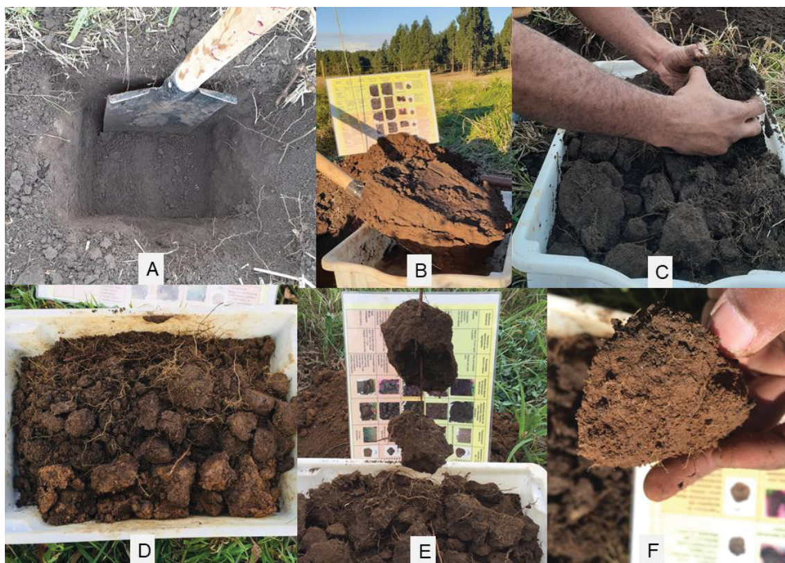
FIGURA 4. MÉTODO DE AVALIAÇÃO VISUAL DA ESTRUTURA DO SOLO
