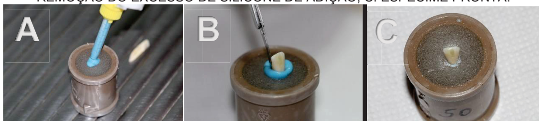
FIGURA 7 – A: SILICONE DE ADIÇÃO INSERIDO NO ESPAÇO FORMADO PELA RAIZ; B: REMOÇÃO DO EXCESSO DE SILICONE DE ADIÇÃO; C: ESPÉCIME PRONTO.
