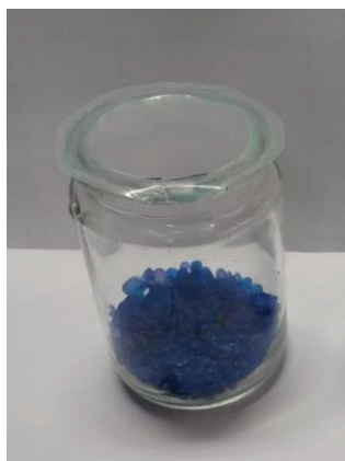
Figura 22 – Cápsula de vidro com o corpo de prova montado e sílica gel
