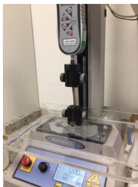
Figura 21 – Preparação para o ensaio de resistência à tração
