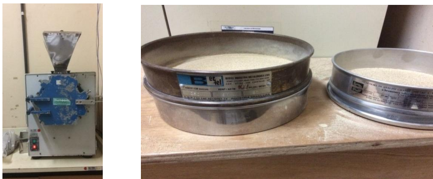
Figura 3 – Moinho de facas tipo Wiley , utilizado no processamento dos cavacos em partículas soltas (esquerda) e peneiras utilizadas (direita).
