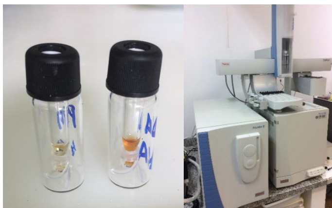
Figura 7 – Amostras prontas para a análise (esquerda), equipamento de cromatografia acoplado ao espectrômetro de massa (GC-MS)
