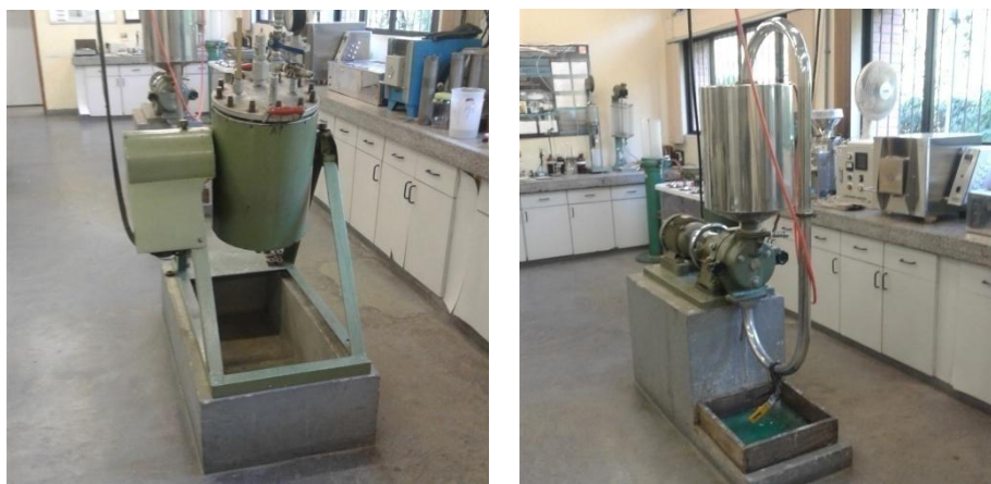
Figura 10 – Reator utilizado para cozimento da polpa celulósica (esquerda) e Desfibrador de discos tipo Bauher(direita)
