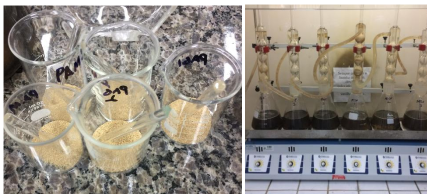
Figura 4 – Amostras prontas para receberem o ácido sulfúrico(esquerda) e amostras em ebulição durante 4 horas(direita).
