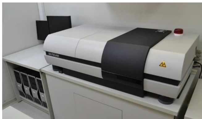
Figura 18 Modelo de micro-CT utilizado para a análise das amostras, conectado a 4 “clusters”. O equipamento está localizado no Instituto Laboratório de Análises de Minerais e Rochas (LAMIR), dentro da UFPR.
