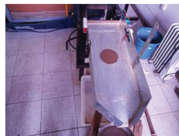
(c) Umedecimento e colocação de fita e papel filme na rampa e ajuste da vazão
