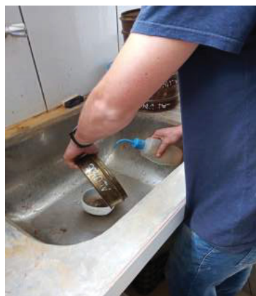
(g) Retirada de material coletado nas peneiras por aspergimento de água e coleta de material úmido em potes de porcelana
