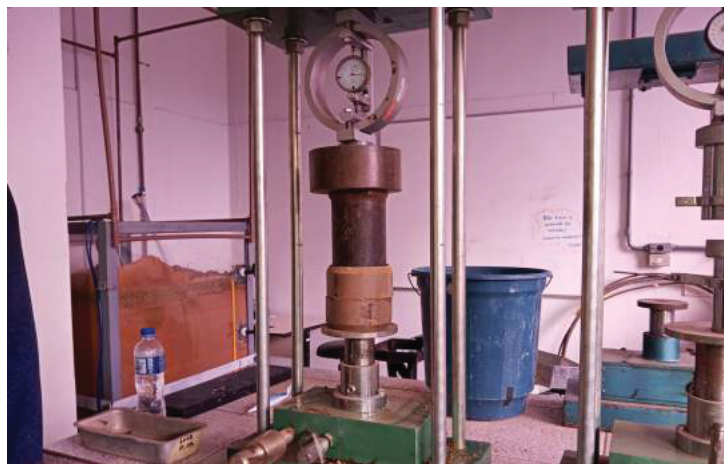
FIGURA 4.13 – Equipamento utilizado para compactação estática e produção dos corpos de prova
