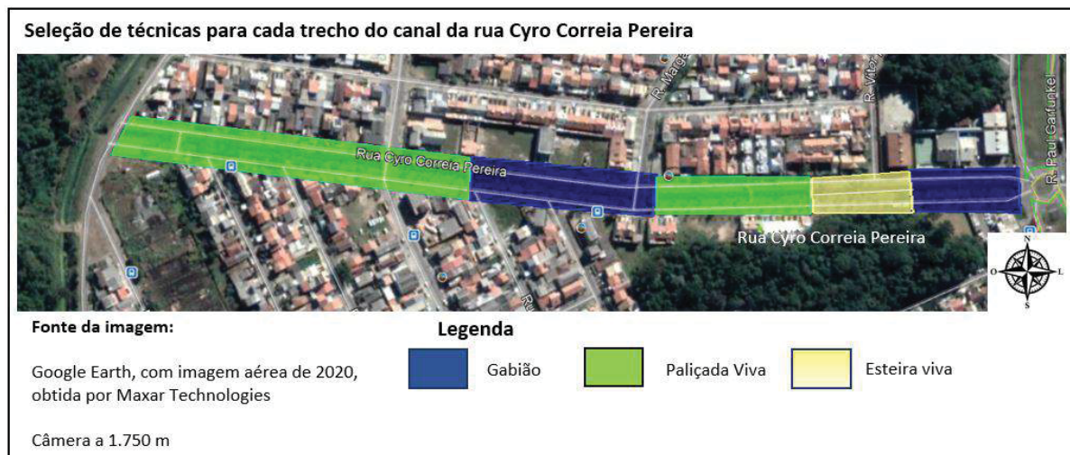
FIGURA 3.15 – Seleção de técnicas no canal da rua Cyro Correia Pereira a partir do levantamento de campo
