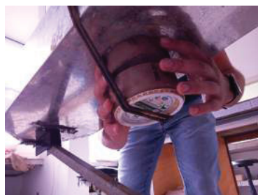
(a) Posicionamento do corpo de prova na rampa e colagem com silicone
