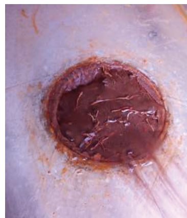
(f) Coleta de teor de umidade final e material desagregado pela água infiltrada
