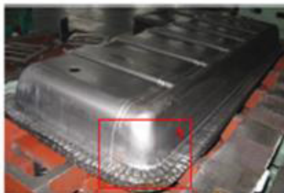
FIGURA 5 – FALHA NA ESTAMPAGEM “RUGAS”
