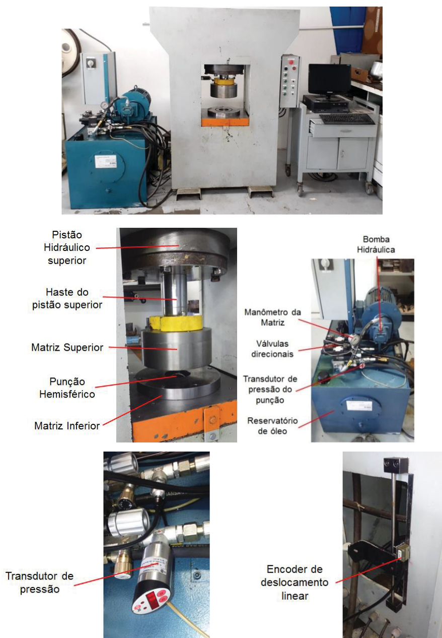
FIGURA 17 - PRENSA HIDRAULICA PARA REALIZAÇÃO DOS ENSAIOS DE ESTAMPAGEM NAKAZIMA
