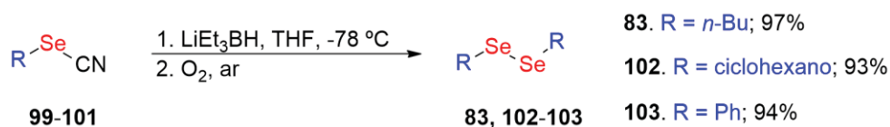
Esquema 16. Síntese de disselenetos a partir da redução de selenocianatos utilizando trietilborohidreto de lítio.
