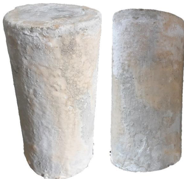
Figura 28 - Aspecto visual da impermeabilização ao final do programa experimental.
