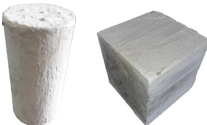
Figura 17 - Aspecto dos corpos de prova após a impermeabilização.
