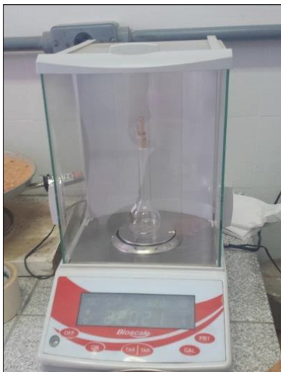
FIGURA 4.4 – PICNÔMETRO SENDO PESADO PARA OBTENÇÃO DE P_1
