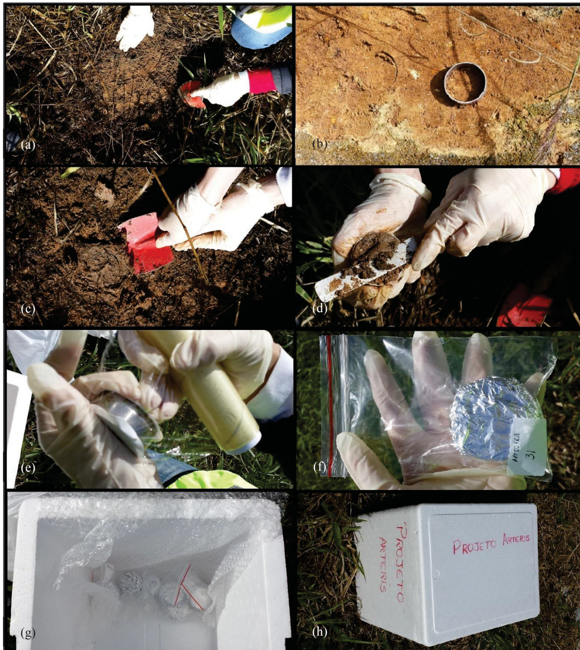
FIGURA 4.18 – PROCEDIMENTOS DE COLETA PARA ENSAIO DE SUÇÃO COM PAPEL FILTRO: (a) LIMPEZA DO LOCAL PARA RETIRADA DE AMOSTRAS, (b) INSERÇÃO DO ANEL NO SOLO, (c) AMOSTRA SENDO RETIRADA COM AJUDA DA PÁ, (d) MOLDAGEM DA AMOSTRA NO TAMANHO DO ANEL, (e) PROTEÇÃO COM PLÁSTICO FILME, (f) AMOSTRA EMBALADA, (g) AMOSTRAS NA CAIXA DE ISOPOR ENVOLVIDAS PELO PLÁSTICO BOLHA e (h) CAIXA DE ISOPOR COM AS AMOSTRAS PARA SEREM TRANSPORTADAS PARA O LABORATÓRIO
