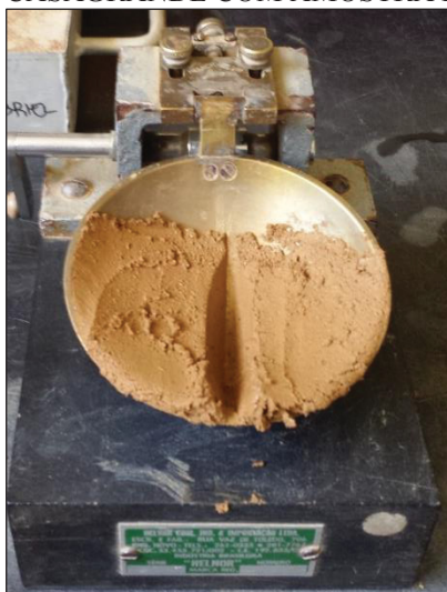
FIGURA 4.16 – APARELHO DE CASAGRANDE COM AMOSTRA PRONTA PARA SER ENSAIADA
