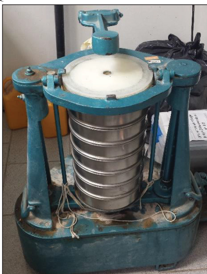
FIGURA 4.9 – SEQUÊNCIA DE PENEIRAS NO AGITADOR MECÂNICO
