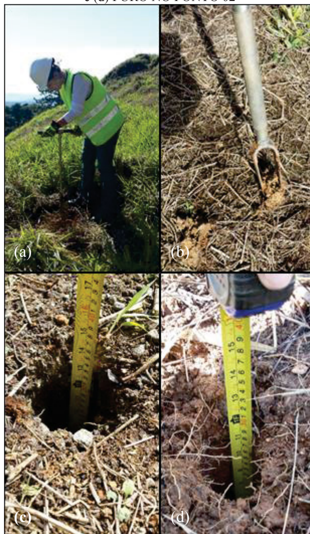
FIGURA 4.21 – REALIZAÇÃO DO ENSAIO DE PERMEABILIDADE: (a) EXECUÇÃO DO FURO COM TRADO, (b) TRADO UTILIZADO PARA RETIRADA DO MATERIAL, (c) FURO NO PONTO 01 e (d) FURO NO PONTO 02
