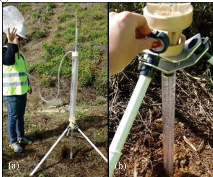
FIGURA 4.23 – EXECUÇÃO DO ENSAIO: (a) ENCHIMENTO DO RESERVATÓRIO e (b) PREENCHIMENTO DOS TUBOS E DO FURO COM ÁGUA
