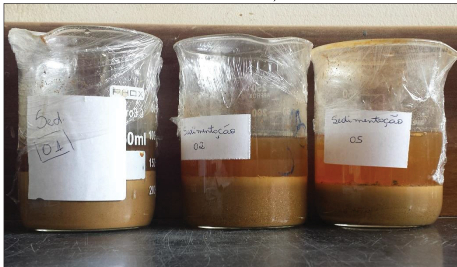
FIGURA 4.10 – MATERIAL EM REPOUSO NA SOLUÇÃO DE HEXAMEFOSFATO DE SÓDIO
