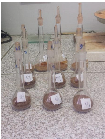
FIGURA 4.5 – PICNÔMETROS COM AMOSTRA DE NO MÍNIMO 10g ( P_2 )
