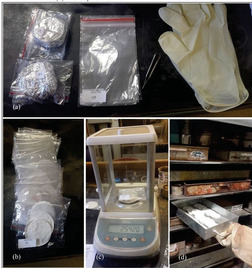
FIGURA 4.19 – ENSAIO DE SUCÇÃO: (a) AMOSTRAS E MATERIAL UTILIZADO, (b) COLETA DO PAPEL FILTRO PARA PESAGEM APÓS ARMAZENAGEM, (c) PESAGEM DO PAPEL FILTRO e (d) INSERÇÃO DO PAPEL FILTRO EM ESTUFA
