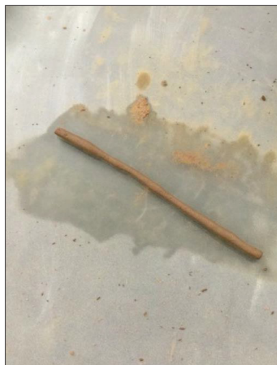
FIGURA 4.15 – AMOSTRA DE SOLO MOLDADA EM CILINDRO
