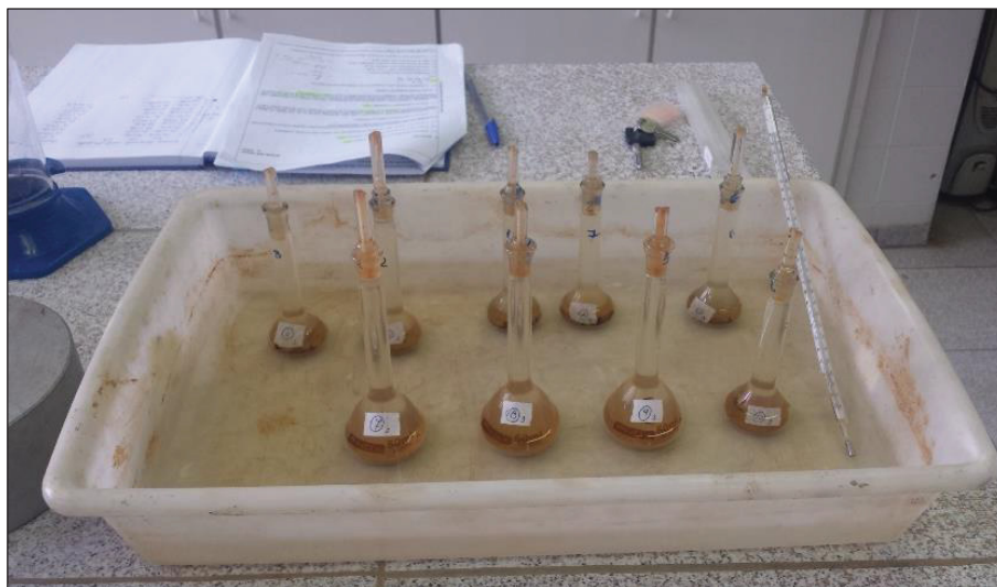
FIGURA 4.7 – PICNÔMETROS COM SOLO E ÁGUA DESTILADA EM BANHO DE ÁGUA ( P_3 )
