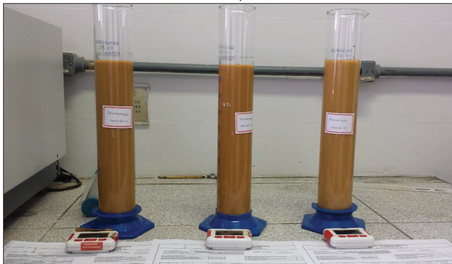
FIGURA 4.12 – SEDIMENTAÇÃO SENDO REALIZADA
