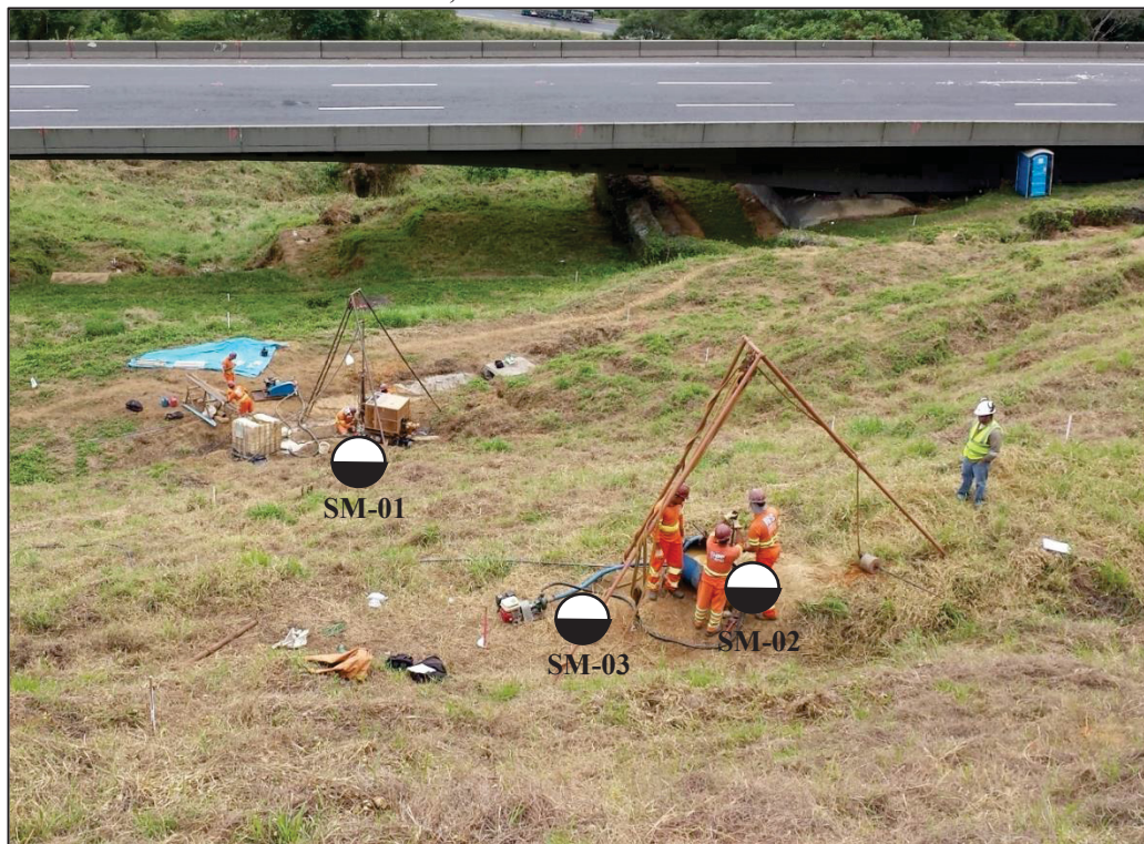
FIGURA 4.8 - SONDAGENS SM-01, SM-02 E SM-03 SENDO REALIZADAS NO KM 552 PN
