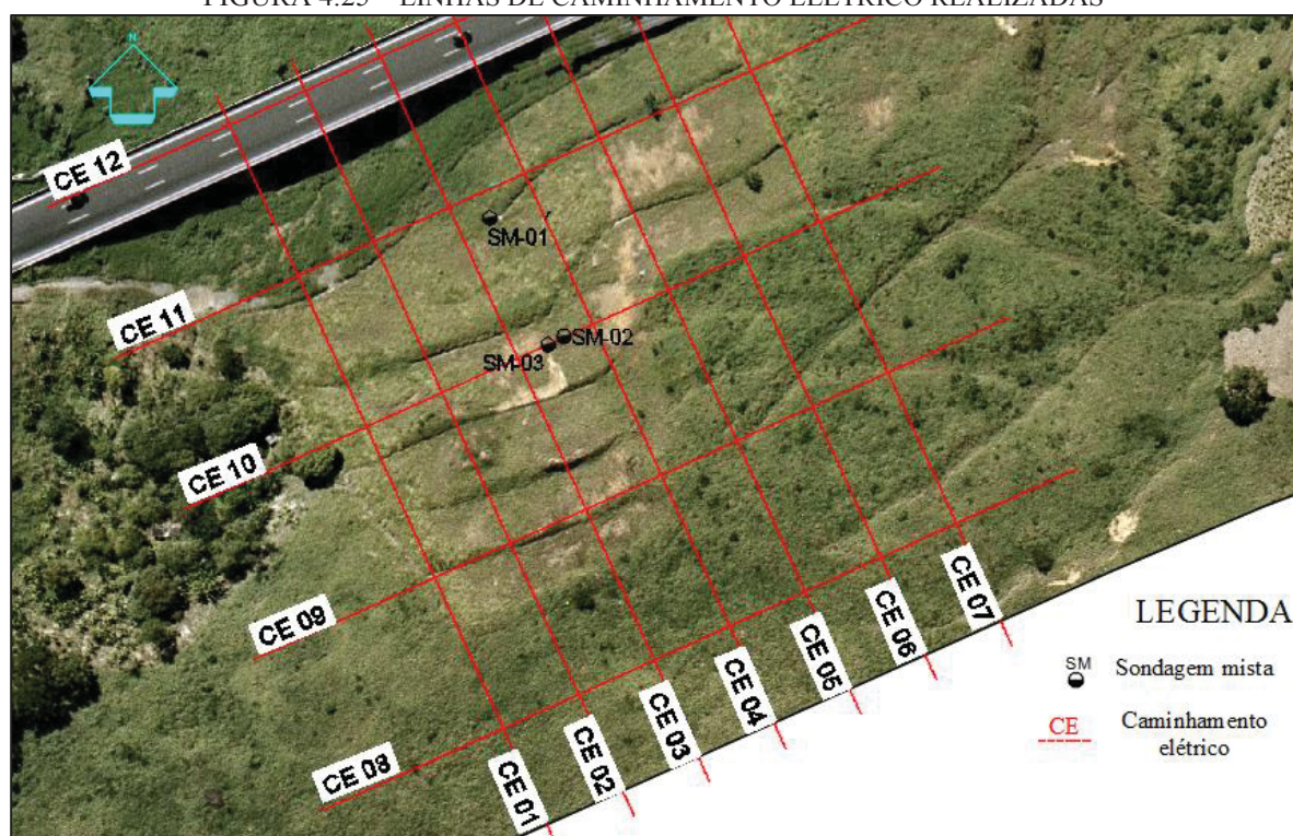
FIGURA 4.25 – LINHAS DE CAMINHAMENTO ELÉTRICO REALIZADAS
