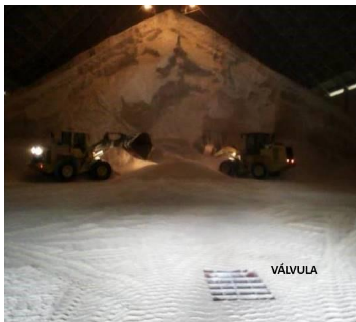
FIGURA 1 - PÁS CARREGADEIRAS ALIMENTANDO VÁLVULAS
