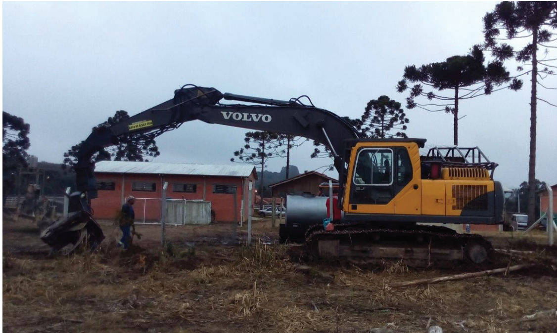
Figura 1. Feller Direcional Satco 630 sob máquina base Volvo 210 , utilizado para efetuar o corte raso.
