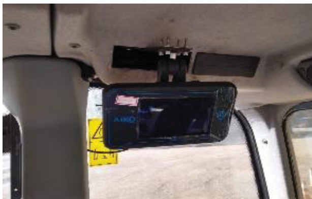
Figura 2a. Computador de bordo instalado no interior da máquina florestal.
