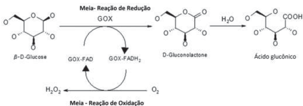
FIGURA 6 - REPRESENTAÇÃO DAS REAÇÕES DE OXI-REDUÇÃO DA GLUCOSE OXIDASE
