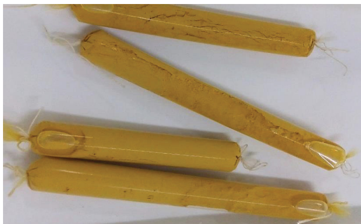
FIGURA 3-REPRESENTAÇÃO ESQUEMÁTICA DE AD3 - DIÁLISE EM BANDEJAS DAS AMOSTRAS DE GOETHITA SATURADAS COM P
