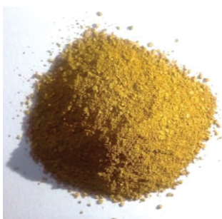
FIGURA 2-REPRESENTAÇÃO ESQUEMÁTICA DE AD2-GOETHITA SINTETIZADA, SECA E MOÍDA
