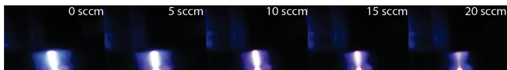
FIGURA 36 - IMAGENS DA DESCARGA EXPANDIDA PARA A SÉRIE DE EXPERIMENTOS M_{1000V}^{155\ \mu m} E_{1000V}^{4,1\ mm} VARIANDO FLUXO DA MISTURA GASOSA DE N_2 + H_2
