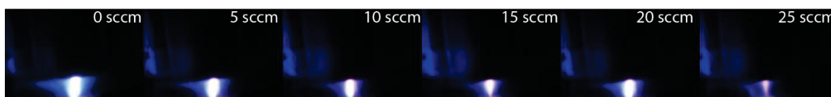
FIGURA 49 - IMAGENS DA DESCARGA EXPANDIDA PARA A SÉRIE DE EXPERIMENTOS M_{1000\text{V}}^{230\mu\text{m}} E_{1000\text{V}}^{3\text{mm}} VARIANDO FLUXO DA MISTURA GASOSA DE \text{N}_2 + \text{H}_2
