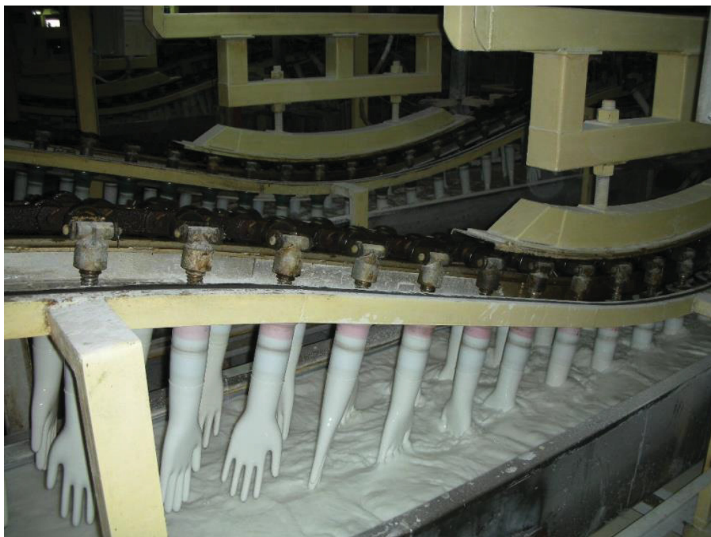
FIGURA 10 – MOLDES PASSANDO PELOS TANQUES DE COMPOSTO DE LÁTEX
