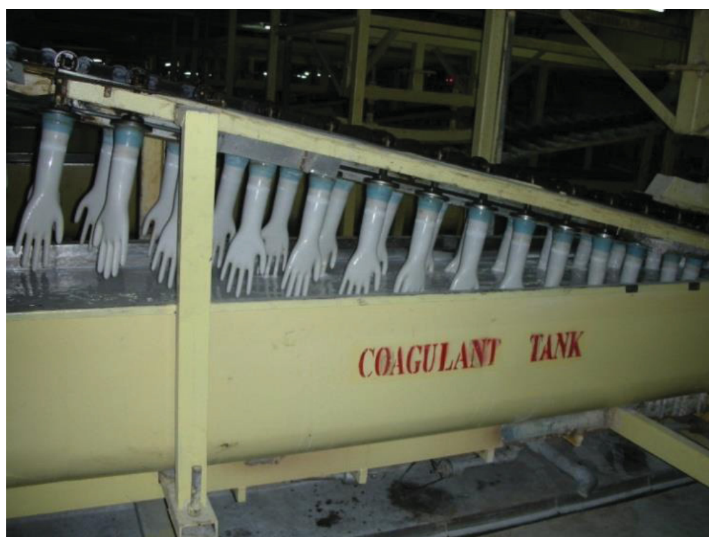
FIGURA 9 – INÍCIO DA LINHA DE PRODUÇÃO DE LUVAS: IMERSÃO EM COAGULANTE
