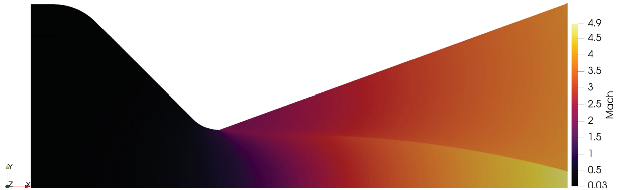
FIGURA 30 – CAMPO DO NÚMERO DE MACH PARA O PERFIL COM N = 1 E RAIOS DE SAÍDA VARIÁVEL
