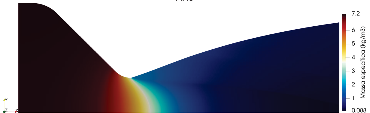
FIGURA 22 – CAMPO DE MASSA ESPECÍFICA PARA O PERFIL COM N = 4 E RAIOS DE SAÍDA FIXO
