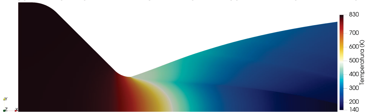
FIGURA 21 – CAMPO DE TEMPERATURA PARA O PERFIL COM N = 4 E RAIOS DE SAÍDA FIXO
