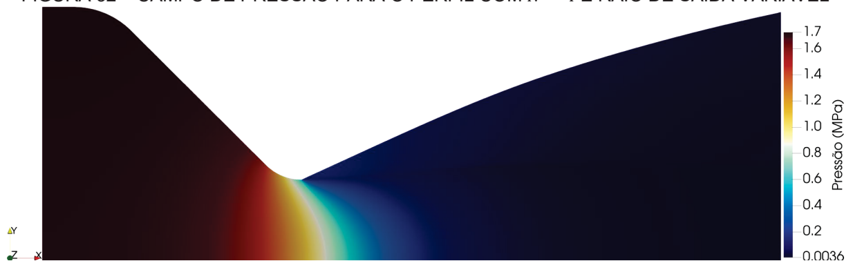
FIGURA 32 – CAMPO DE PRESSÃO PARA O PERFIL COM N = 4 E RAIOS DE SAÍDA VARIÁVEL
