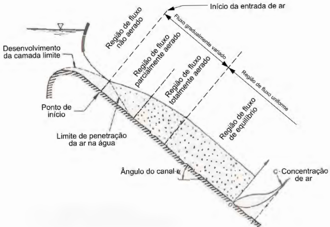
FIGURA 2.1 – AUTO-AERAÇÃO NO VERTEDOURO
