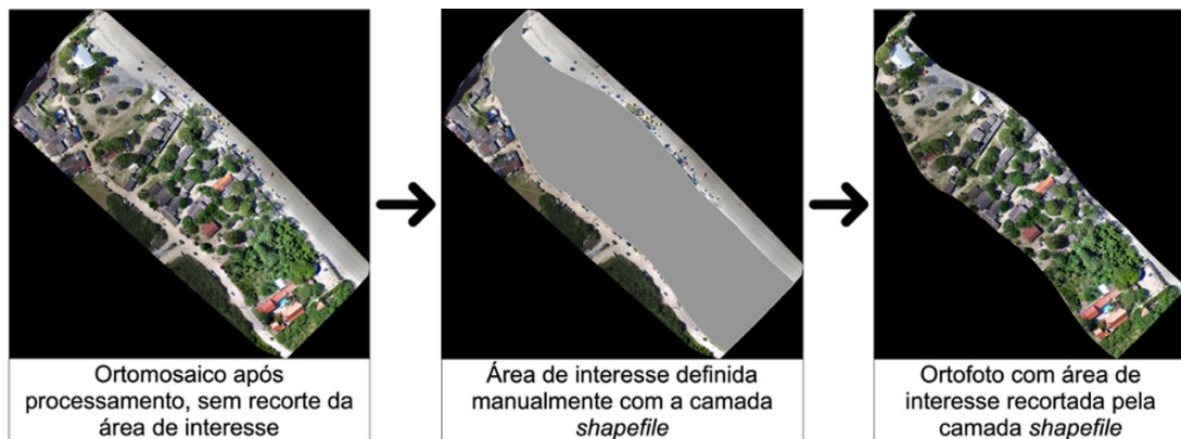
FIGURA 6 – PROCESSAMENTO DAS IMAGENS OBTIDOS NO PLANO DE VOO E PROCESSAMENTO NO SOFTWARE OPENDRONEMAP PARA A PRODUÇÃO DE ORTOMOSAICOS OU ORTOFOTOS
