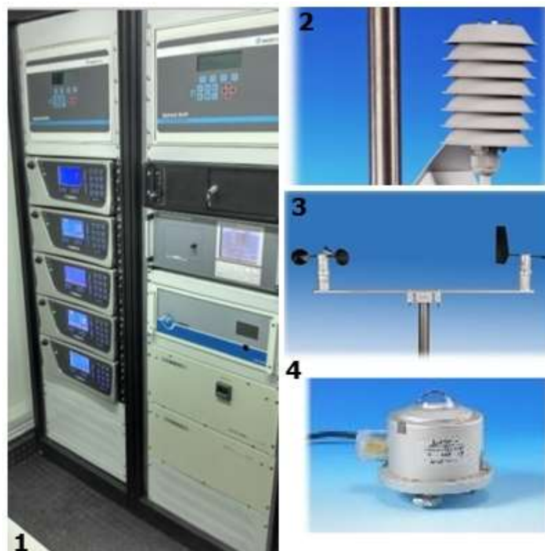
FIGURA 3 - PARTE INTERNA DA ESTAÇÃO DE QUALIDADE DO AR. NO PAINEL 1 ESTÃO OS ANALISADORES, NO PAINEL 2 O ABRIGO DO TERMOHIGRÔMETRO, NO PAINEL 3 O ANEMÔMETRO E NO PAINEL 4 O PIRANÔMETRO.
