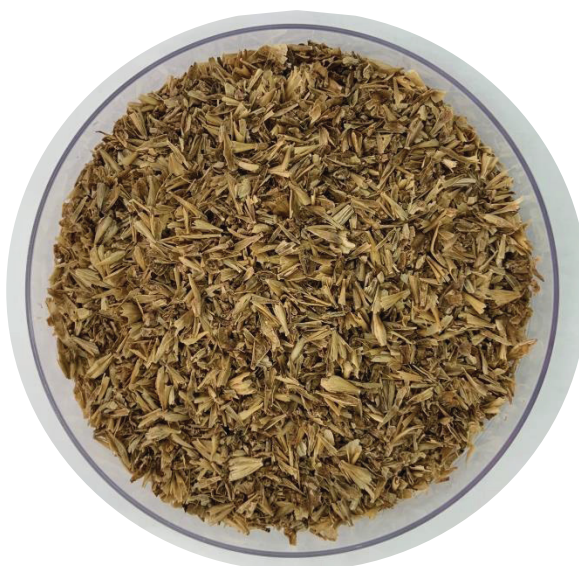
FIGURA 7 - BAGAÇO DE MALTE APÓS SECAGEM E MOAGEM.
