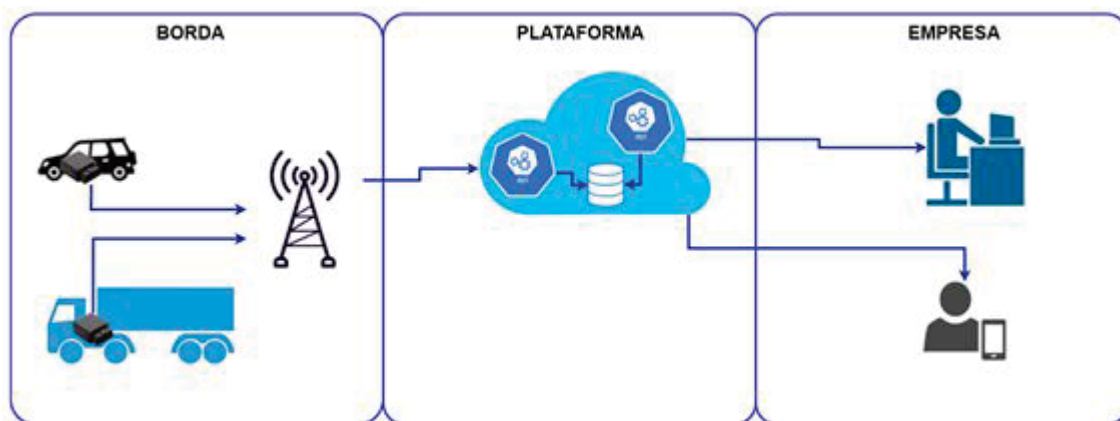
Figura 12: Arquitetura do sistema de monitoramento veicular. (O Autor, 2020)
