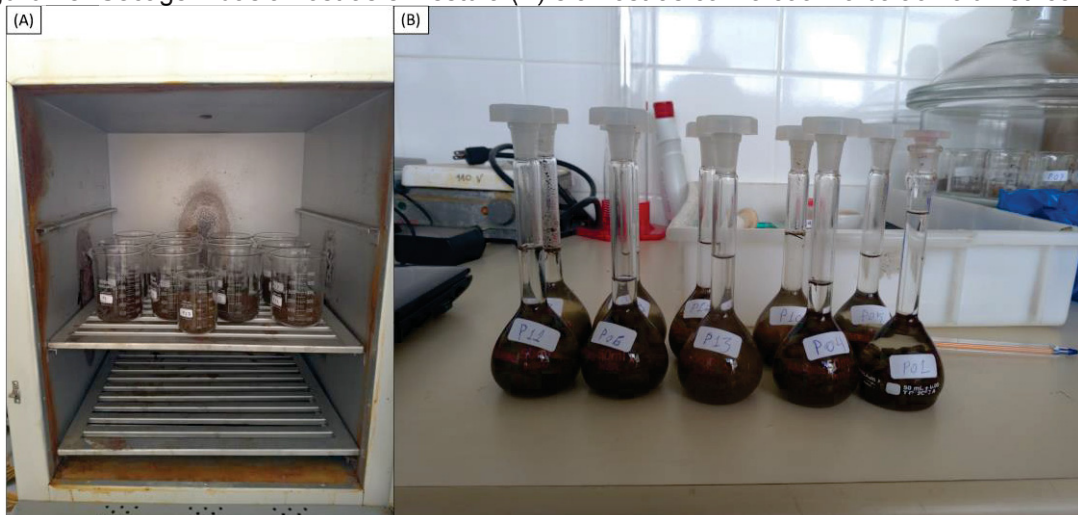
Figura 28: Secagem das amostras em estufa (A) e amostras com álcool no balão volumétrico (B).
