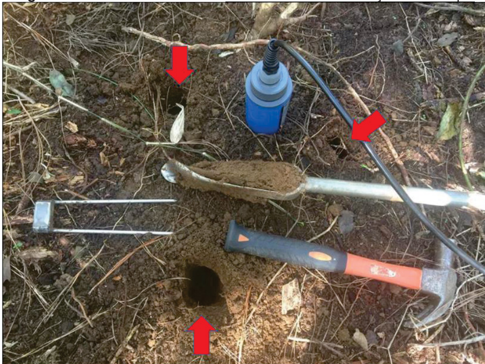
Figura 35: Sonda de TDR TRIME-PICO 64 realizando medições em campo.
