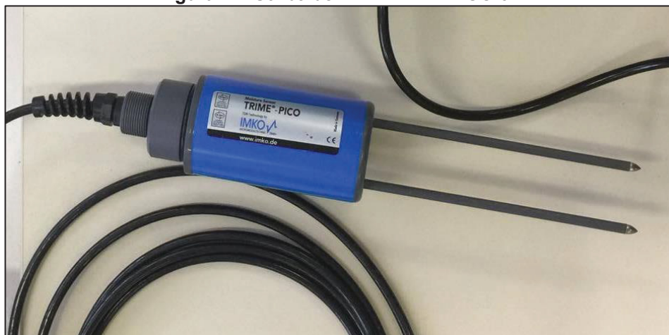
Figura 12: Sonda de TDR TRIME-PICO 64.
