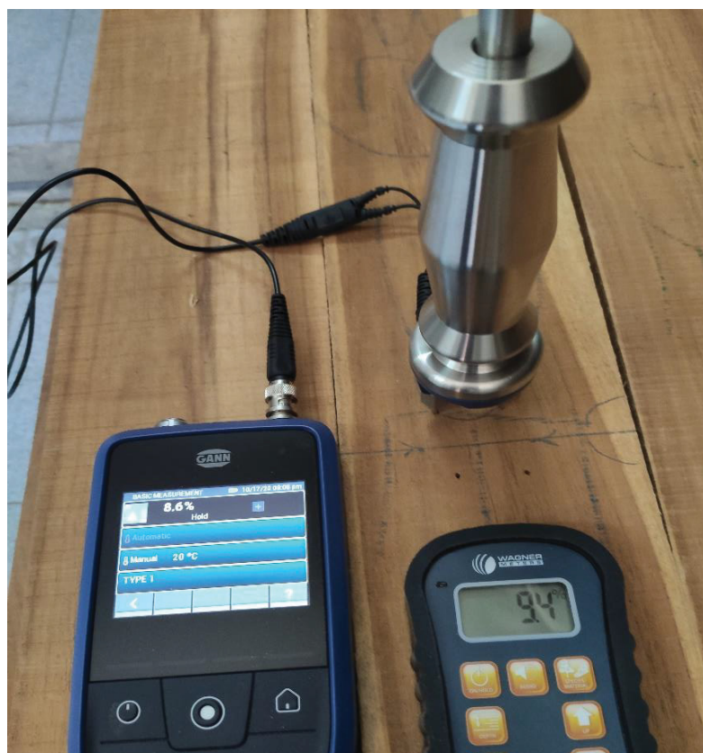
FIGURA 27 - MEDICIÓN DE LA HUMEDAD FINAL CON DETECTORES PORTATILES DE PINES Y CONTACTO EN MADERA SECA ARTIFICIALMENTE DE Tectona grandis DE 33 AÑOS - PERÚ.
