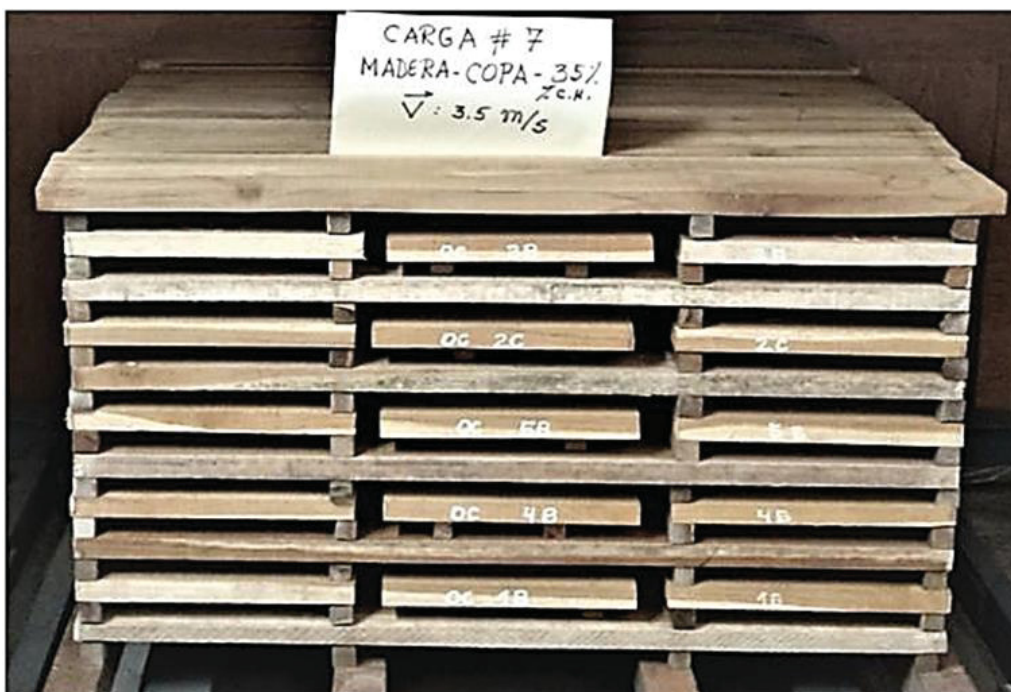
FIGURA 6 - CARACTERÍSTICAS DE LA CARGA DE MADERA DE Tectona grandis PARA EL SECADO AL AIRE LIBRE Y CONVENCIONAL.
