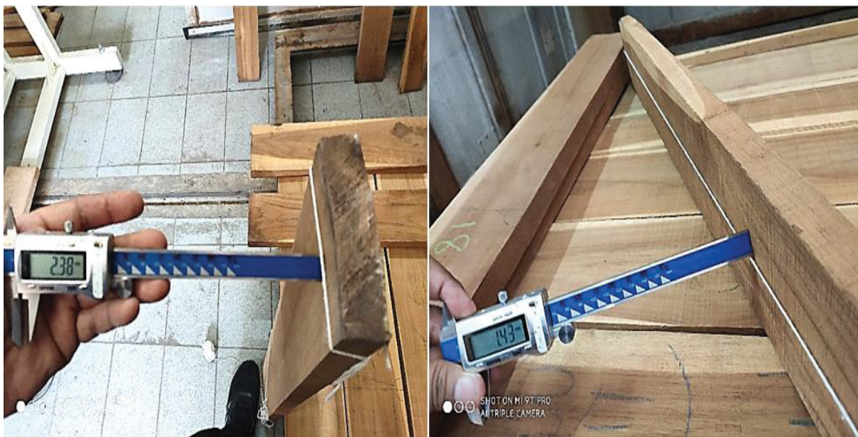
Fotos: Izquierda: acanalado; Derecha: combado. FUENTE: El autor (2020).
