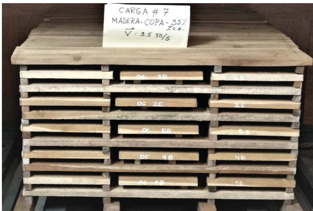
FIGURA 18 - CARGA DE MADERA N° 7 DE Tectona grandis DE 33 AÑOS DEL PERÚ AL TÉRMINO DEL PERIODO DE SECADO AIRE.
