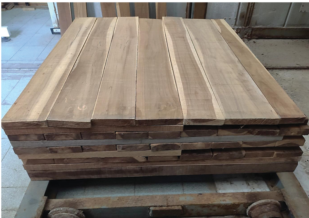
FIGURA 30 - MADERA DE TECA DE 33 AÑOS DEL PERÚ SIN DEFECTOS DE GRIETAS EN EXTREMOS, CARAS Y COLAPSO VISIBLE AL TERMINO DEL SECADO ARTIFICIAL.
