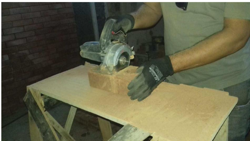
**Figura 19** - Corte de tijolo ao meio para ensaio de compressão.
