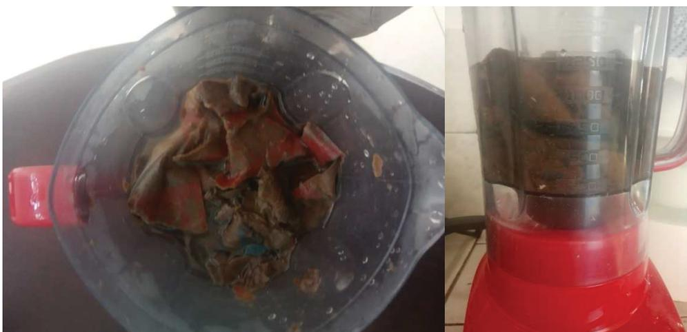
**Figura 10** - Liquidificador doméstico utilizado para produzir a poupa.
