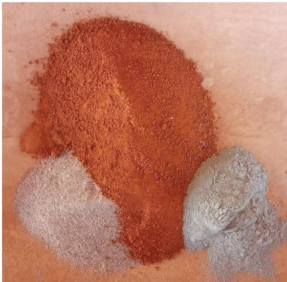
**Figura 12** - Terra, areia para correção do solo e cimento.
