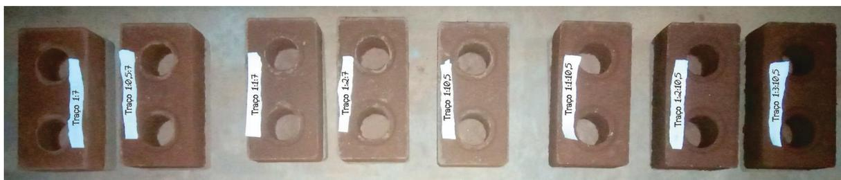
**Figura 18** - Tijolos em processo de cura.
