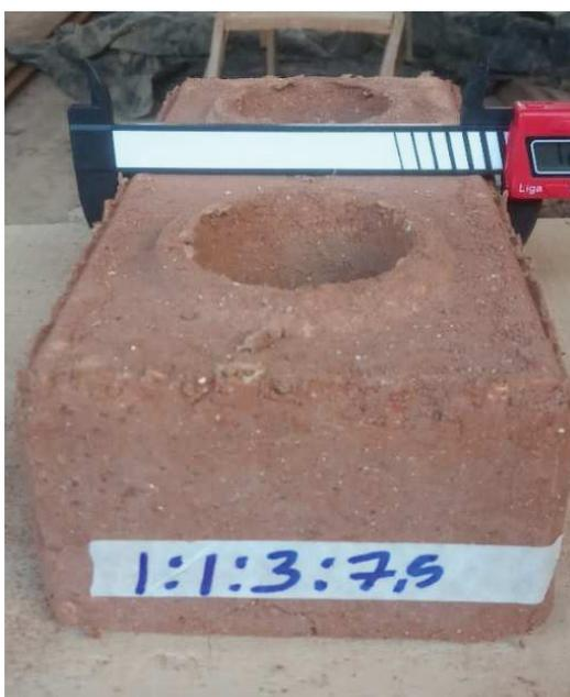
**Figura 23** - Medição com paquímetro para teste dimensional.
