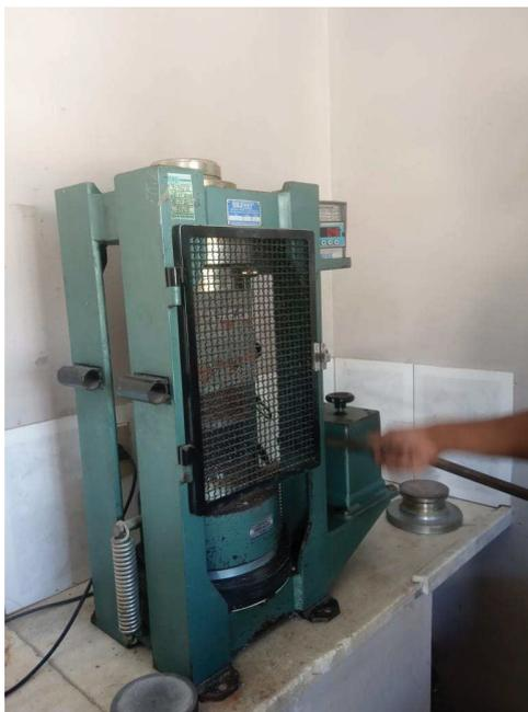
**Figura 22** - Prensa hidráulica para resistência a compressão.
