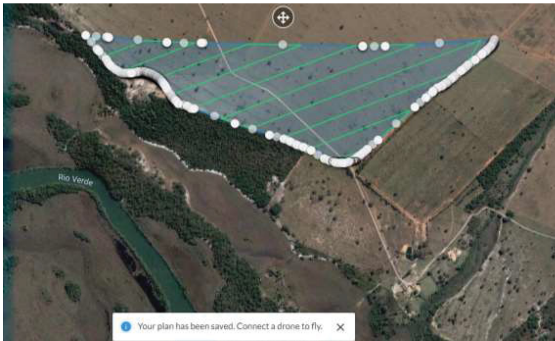
Figura 3: Planejamento de voo em Software Drone Deploy
