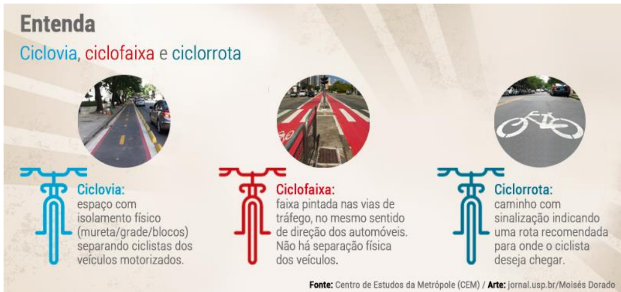
Figura 4 - Elementos da infraestrutura cicloviária básica
