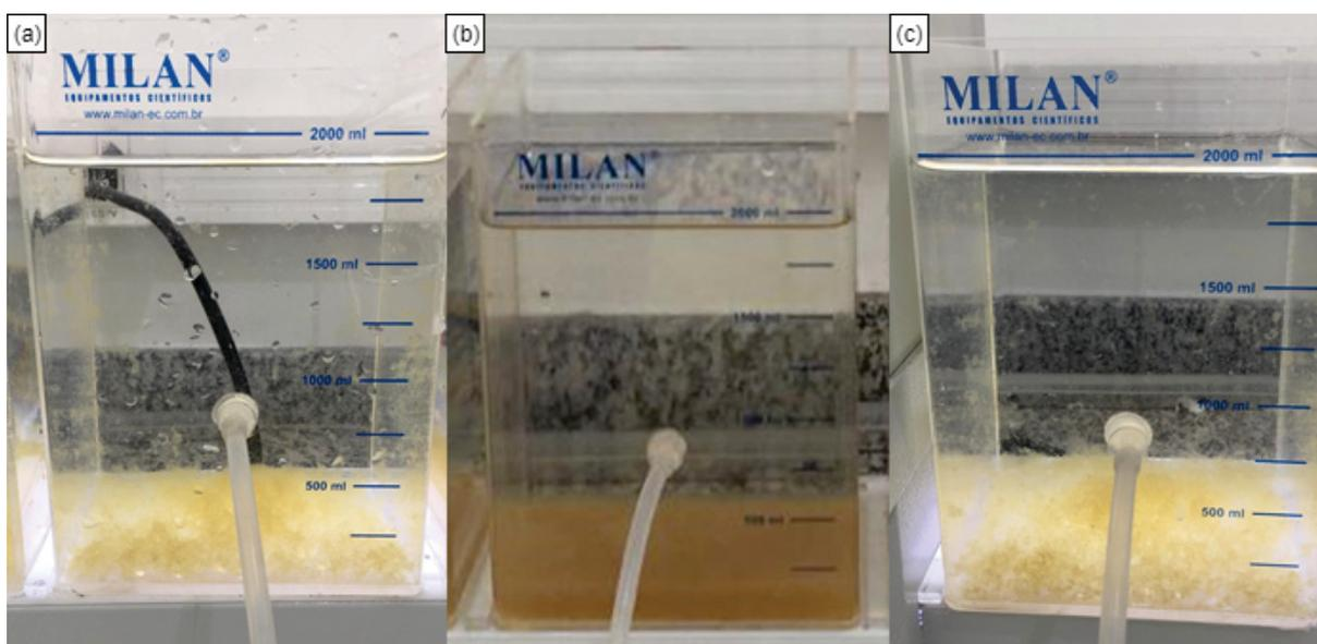
FIGURA 36 – Lodo formado no processo físico-químico seguido de sedimentação, com a utilização de Polímero Aniônico, orgânico e catiônico. (a) Polímero Catiônico:  $1,0 \text{ mg.L}^{-1}$ ; (b) Polímero Orgânico:  $0,25 \text{ mg.L}^{-1}$ ; Polímero Aniônico:  $0,50 \text{ mg.L}^{-1}$
